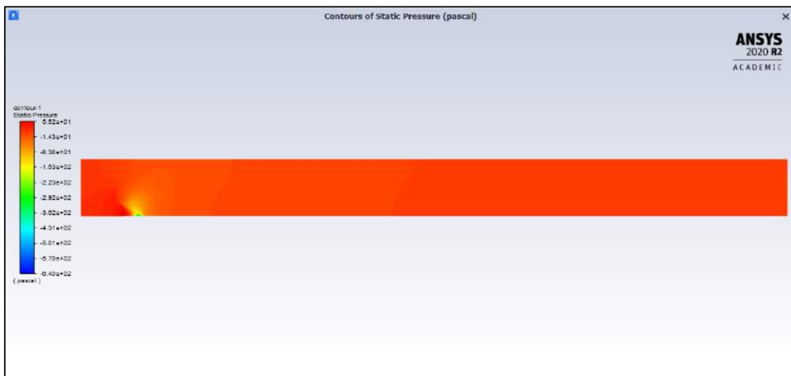
Ilustración 6.11 Presiones estudio interacción de fases: PAL 50, \dot{m} = 1,2 \text{ kg/s} , V = 3x \text{ m/s} , \theta = 35^\circ y \varnothing = 150 \mu\text{m} (cortesía ANSYS, Inc.)
