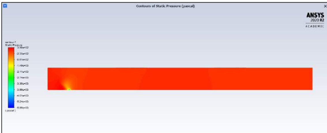
Ilustración 6.16 Presiones estudio viabilidad operativa: PAL 100, \dot{m} = 3,0 \text{ kg/s} , V = 4x \text{ m/s} , \theta = 35^\circ y \varnothing = 100 \mu\text{m} (cortesía ANSYS, Inc.)
