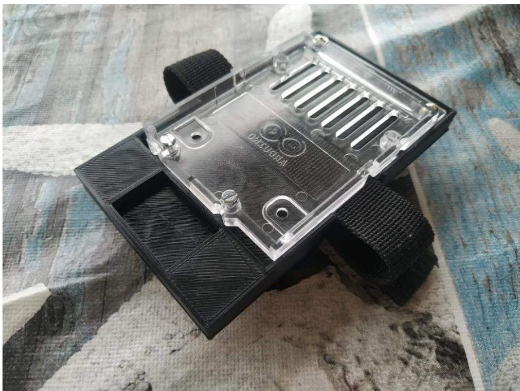
*Figura 45: Brazaletes impreso con el soporte del Arduino atornillado*
