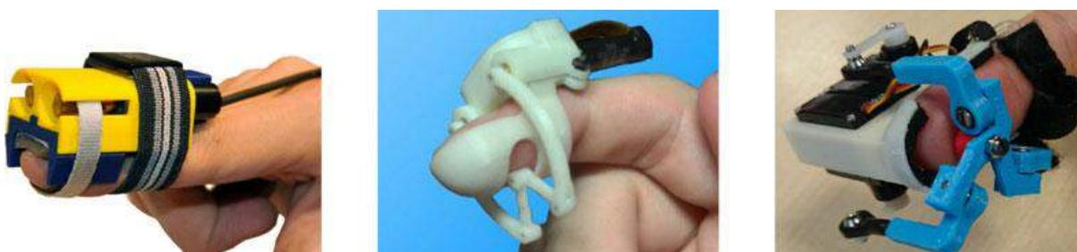
*Figura 17: Prototipos con estiramiento lateral de la piel o movimiento tangencial relativo [16]*
