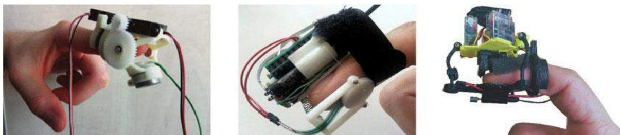
*Figura 16: Prototipos con contacto normal a la yema del dedo [16]*
