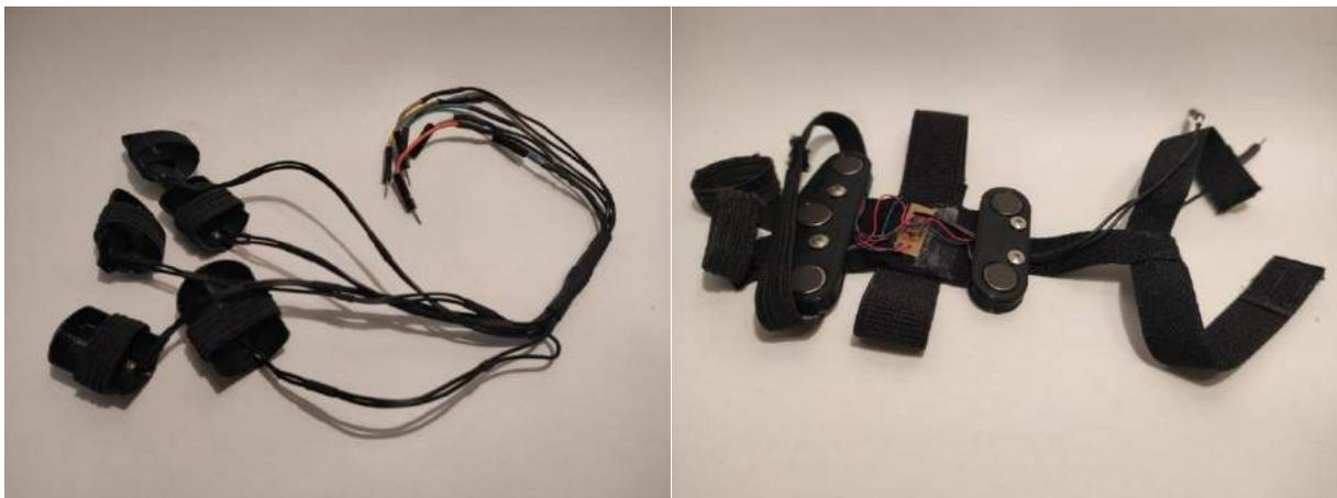
*Figura 71: a) Dedales del prototipo I montados b) Plataforma de la palma montada*
