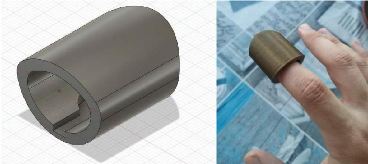
Figura 34: Primer dedal a) Modelo en Fusion360 b) Modelo impreso
