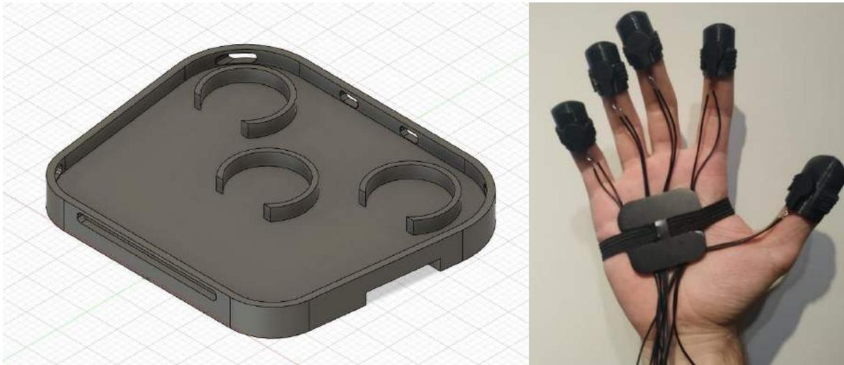
Figura 37: Primer prototipo de la palma a) Modelo en Fusion360 b) Modelo impreso
