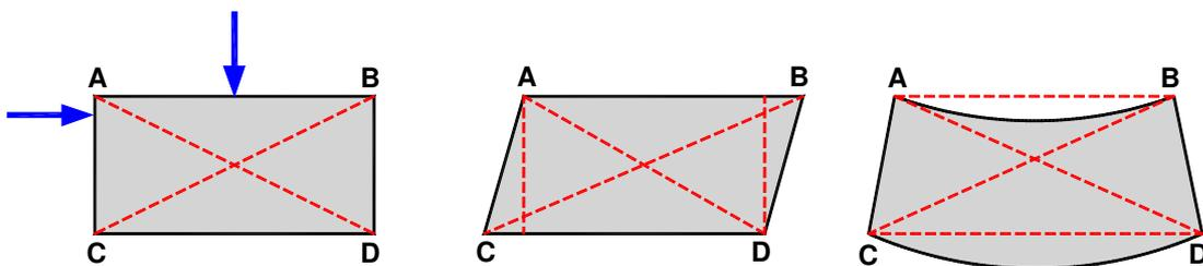
Figura 2 – Corpo deformável
