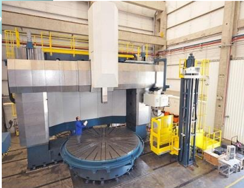
Placa, de 5 m de diâmetro, suporta até 90 toneladas
