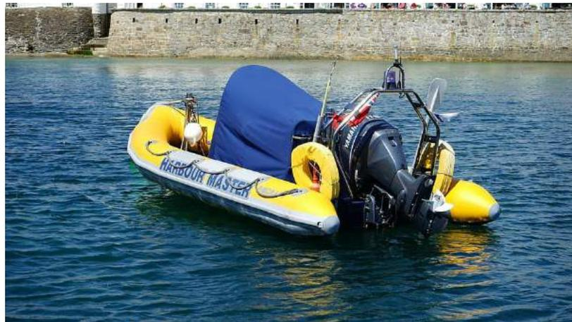
Figura I.1. Barco Auxiliar Inflable con Suelo Rígido que permite transportar un peso considerable
