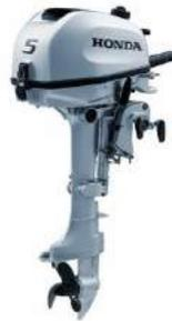
**Figura I.14.-** Motor fueraborda Honda BF5A, equipada con la hélice
