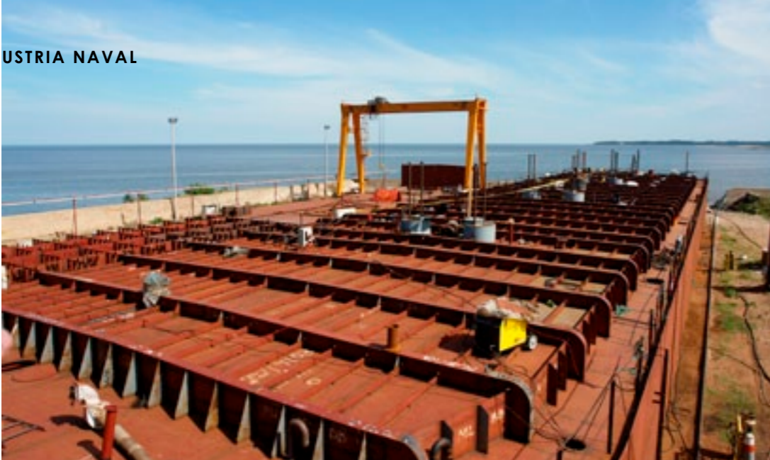
La barcaza cisterna tiene 71 metros de eslora por 14.50 de manga y será capaz de transportar 2.150 m 3 de combustible.
