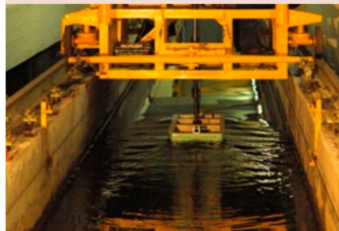
El canal de pruebas de Facultad de Ingeniería permite realizar estudios hidrodinámicos imprescindibles para la construcción de embarcaciones.
