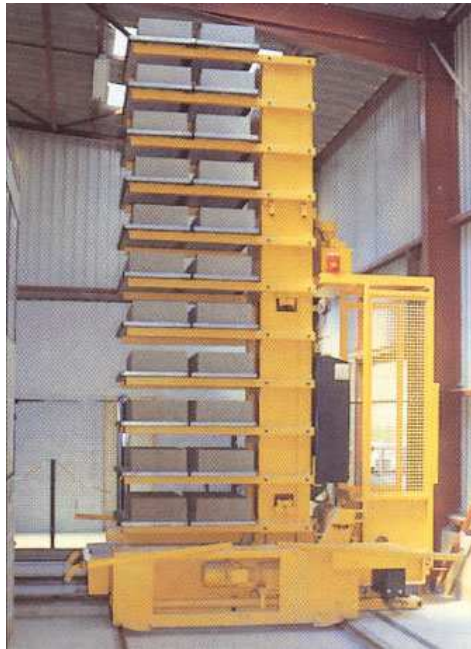
Fig. 11 – Elevador de transporte de elementos “frescos” ou “verdes” moldados sobre pranchas
