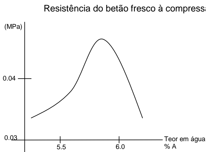
Fig. 12 – Evolução da resistência à compressão do betão fresco com o teor de água
