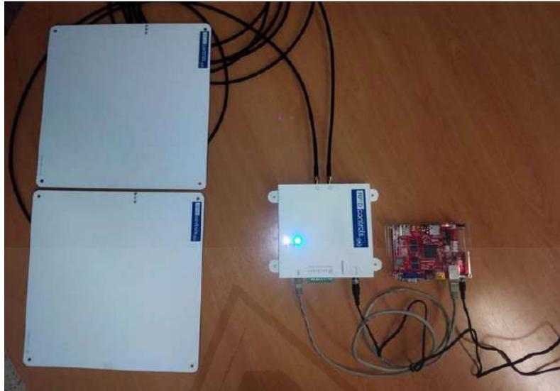
(b) Sensor Inteligente RFID con Sistema Embebido.
