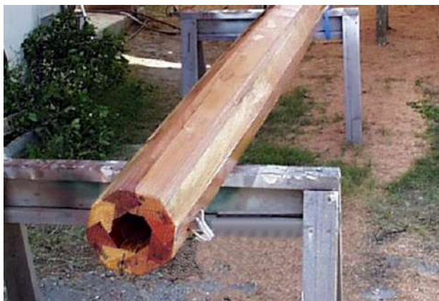
Ilustración 19: Mástil de encolado hueco;
