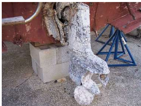
Ilustración 56: Corrosión galvánica en un intrafueraaborda, Fuente: lake-hartwell.org
