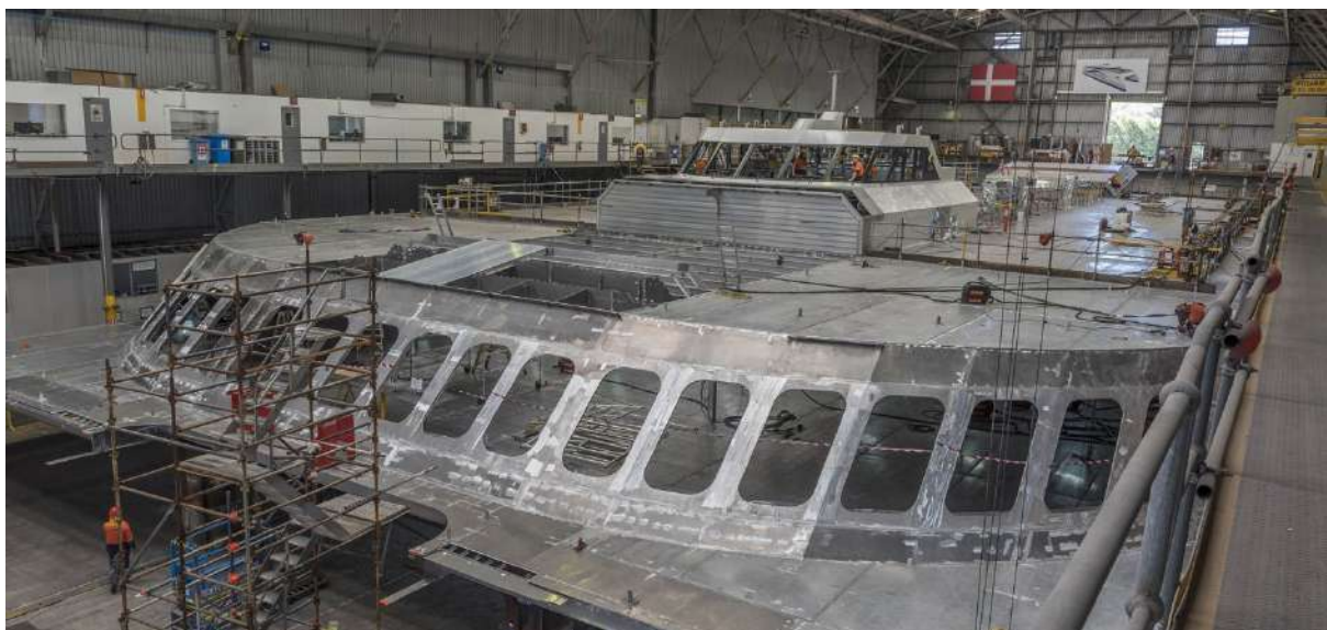
Ilustración 72: Construcción de la superestructura de un catamarán en Austal, Fuente: austal.com
