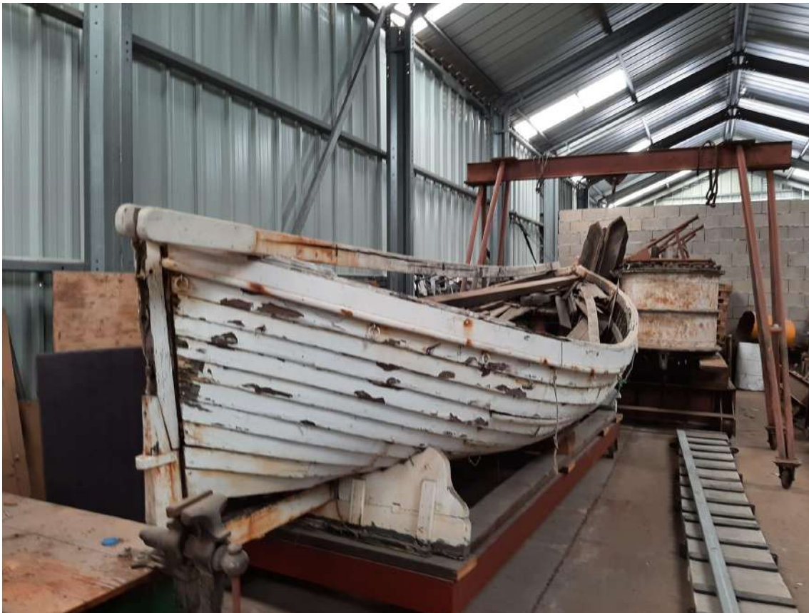
Ilustración 43: Forro de Tingladillo, bote salvavidas del vapor LA PALMA; Fuente: trabajo propio.
