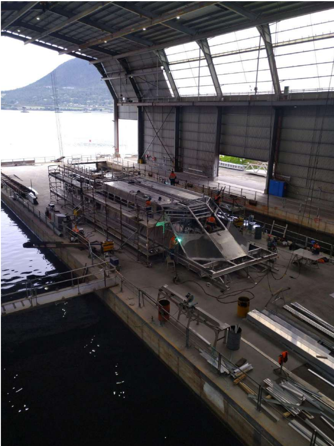
Ilustración 68: Montaje del puente de mando de un catamarán de pasaje,, Fuente: fotografías del profesor tutor de este TFG.
