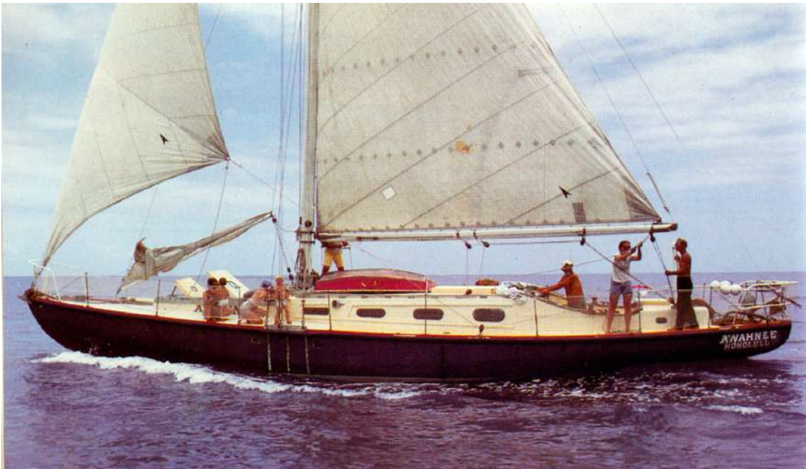
Ilustración 121: Velero neozelandés "Awahnee", yate construido en ferrocemento; recorrió el mundo con éxito. Fuente: vadebarcos.net
