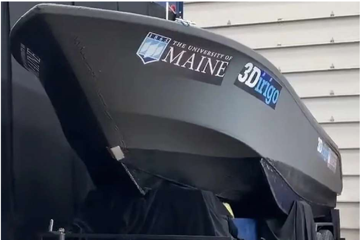
Ilustración 148: 3Dirigo, embarcación construida por impresión en fibras de madera. Fuente: covissa.com
