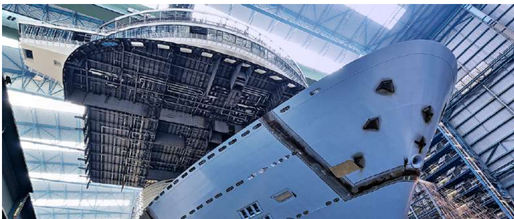
Ilustración 110: Construcción de un buque por secciones, Astilleros Meyer Werft Papenburg. Fuente: meyerwerft.es
