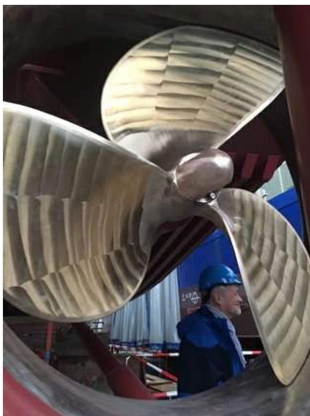
Ilustración 145: Hélice “WAAMPeller”, primera hélice construida por impresión 3D, incorpora 298 capas de una aleación de bronce, aluminio y níquel. Fuente: Revista TCT.
