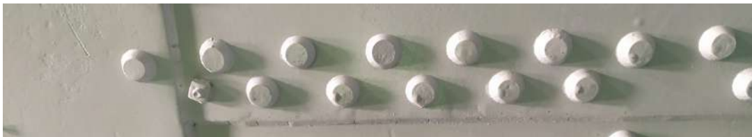
Ilustración 103: Remachado en zigzag, vapor LA PALMA ; Fuente: elaboración propia.
