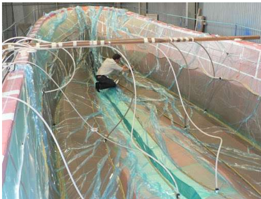
Ilustración 136: moldeado al vacío de una embarcación, Fuente: astilleros-nicolau.com
