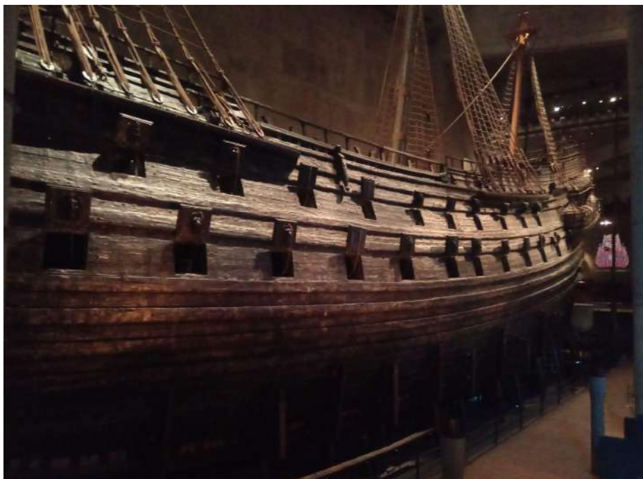
Ilustración 42: Forro liso del navío VASA, en el Museo de Vasa de Estocolmo; Fuente: trabajo cedido por el tutor de este TFG
