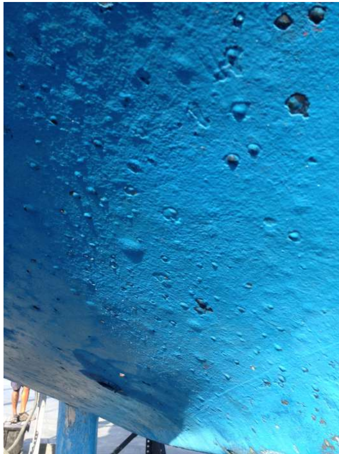
Ilustración 138: Ósmosis en un casco de fibra de vidrio, principal problema de las embarcaciones de material compuesto La ósmosis se produce al entrar agua entre el gelcoat y el laminado de debajo, Fuente: yacht-painters.com
