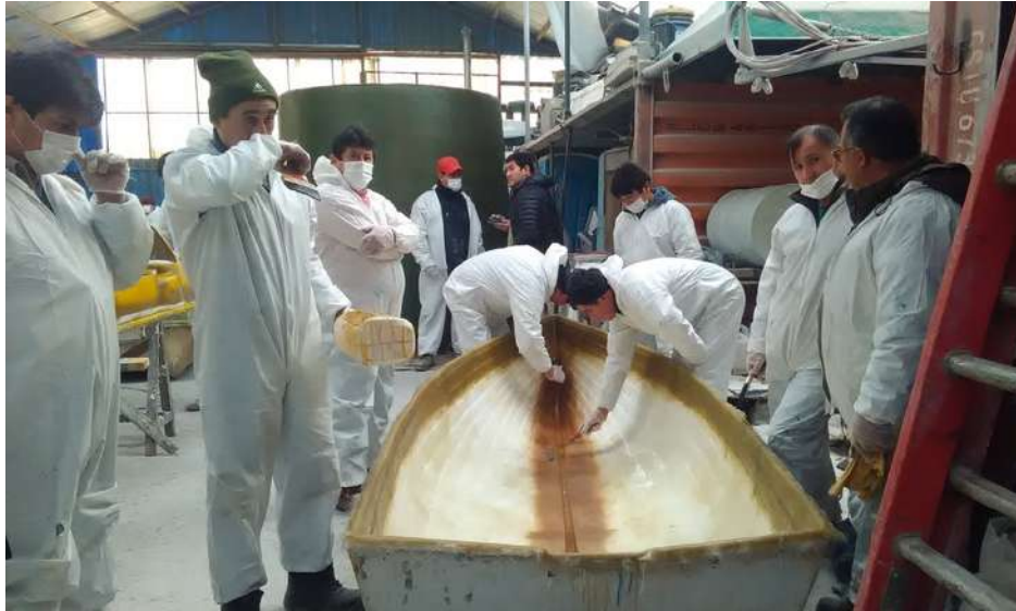
Ilustración 137: moldeado en frío de una embarcación, Fuente: subpesca.cl
