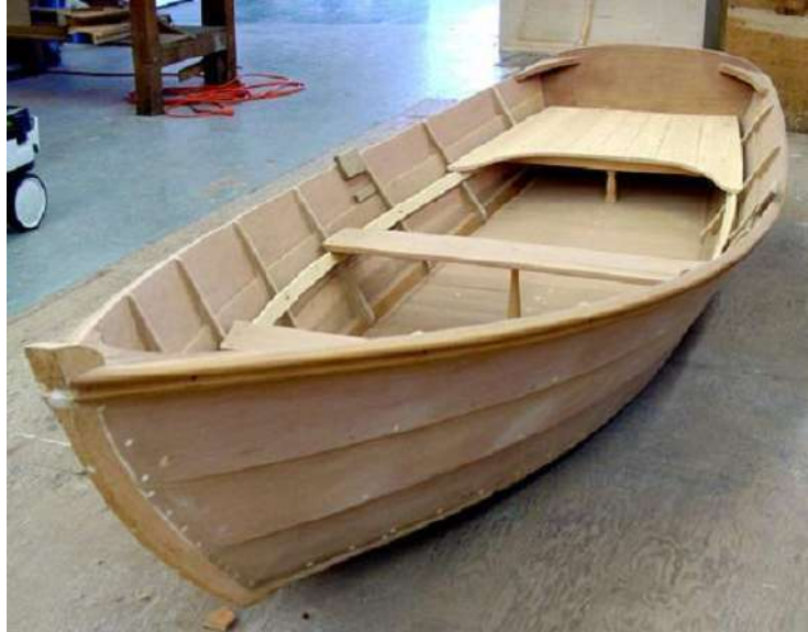
Ilustración 47: Forro de tingladillo contrachapado; Fuente: epoxycraft.com
