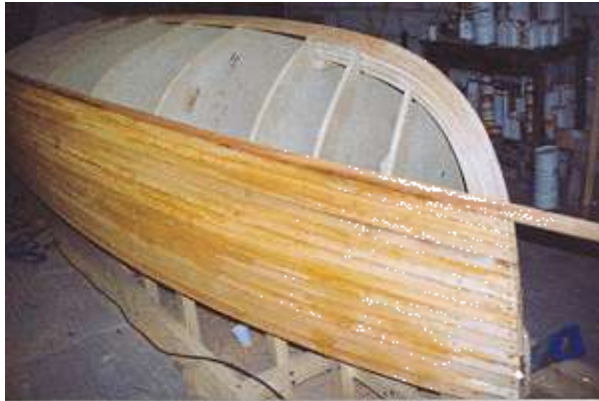
Ilustración 45: Forro de listones; Fuente: selway-fisher.com
