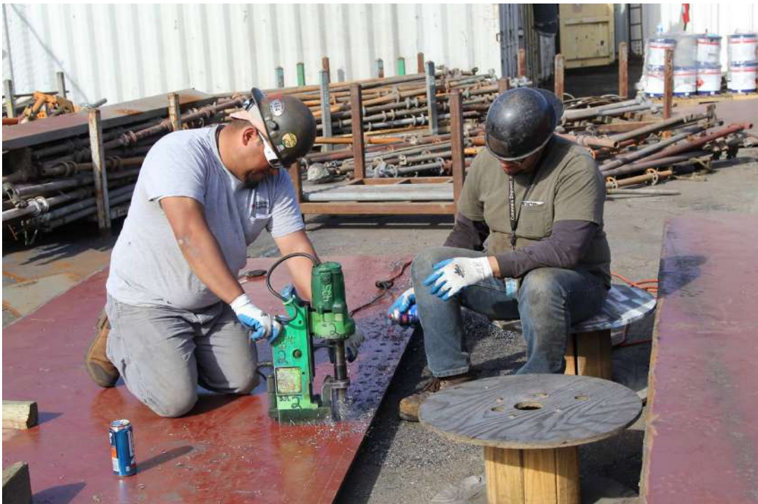
Ilustración 89: perforación de planchas con un punzón eléctrico; Fuente: SS John W. Brown, Project Liberty Ship (Facebook)
