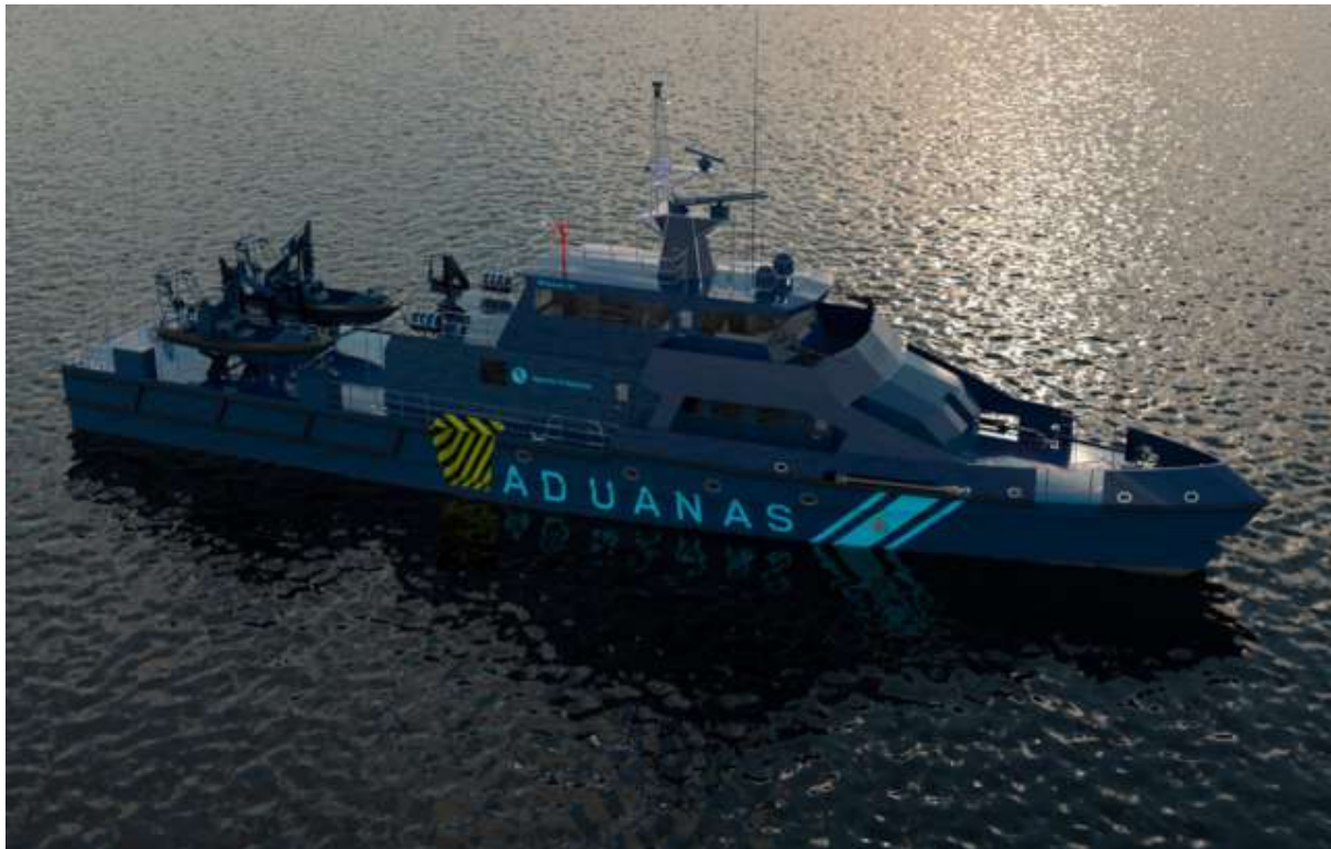
Ilustración 143 : Patrullera “CONDOR” (Rodman 138). Es la patrullera más grande de Europa construida en PRFV (Poliéster Reforzado con Fibra de Vidrio) , Fuente: rodman.es
