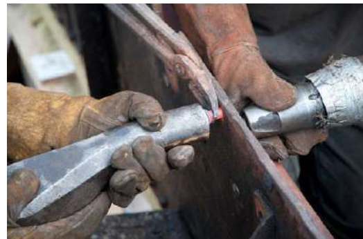
Ilustración 93: Sustentador sosteniendo el remache mientras el remachador realiza su trabajo; Fuente: boat-building.com
