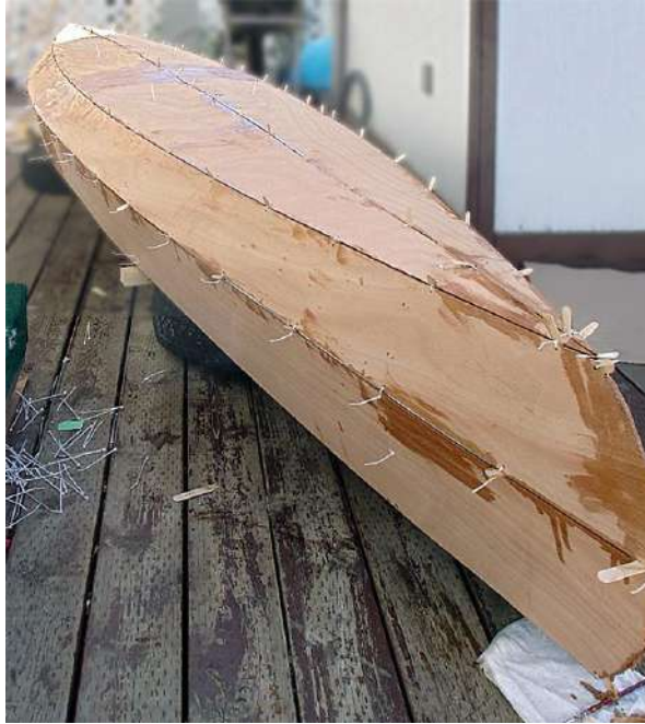
Ilustración 48: Forro cosido de una canoa; Fuente: en.wikipedia.com
