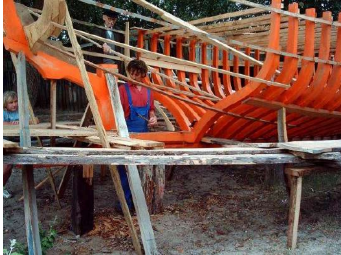
Ilustración 11: Impregnación en base de minio (Galicia), Fuente: ideal.es
