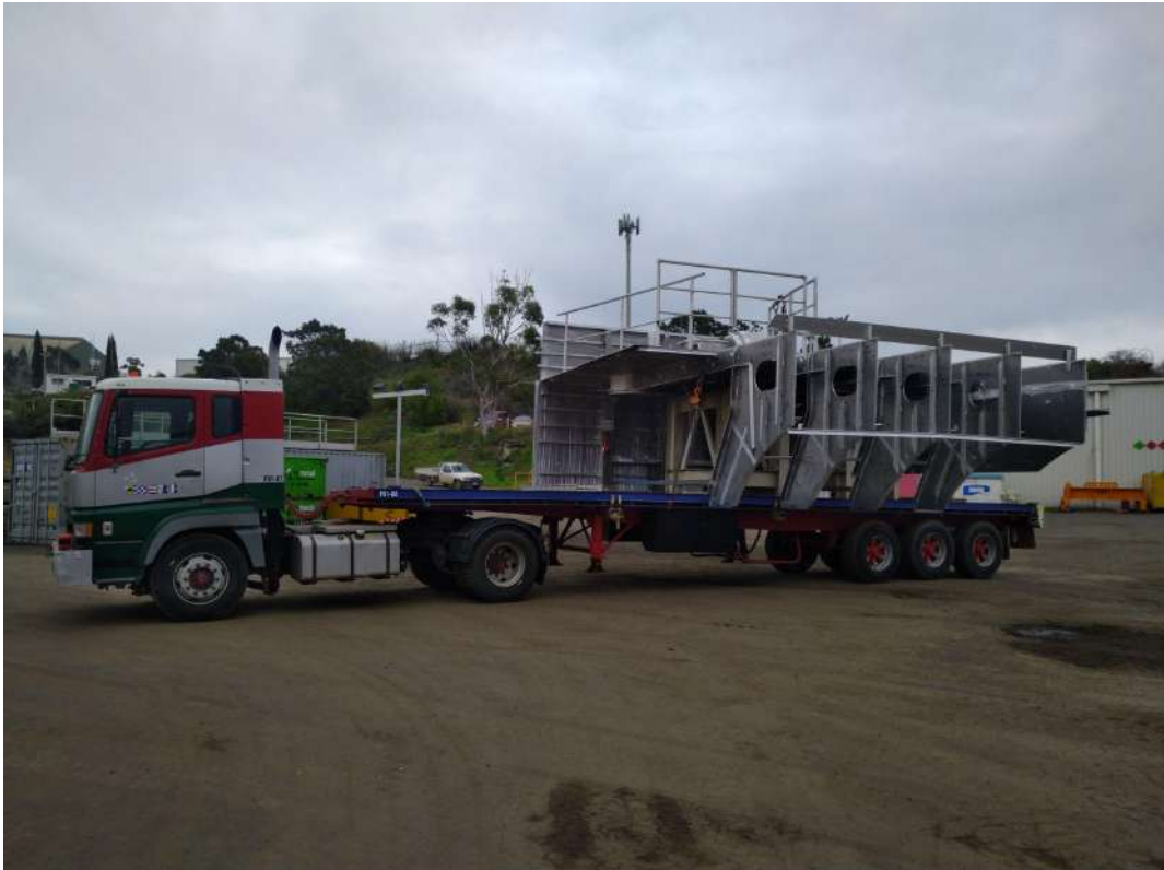
Ilustración 66: Transporte de un módulo del casco de un buque de aluminio, Fuente: fotografías del profesor tutor de este TFG.
