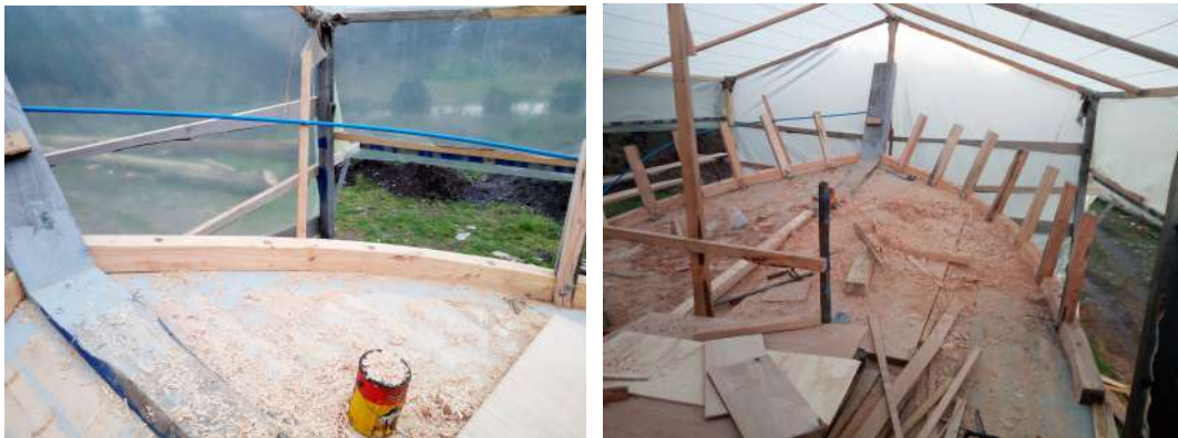
Ilustración 13 y 14: Proceso de montaje de barraganetes e instalación (Calbuco, Chile); Fuente: @carpinteríaderibera (Facebook)
