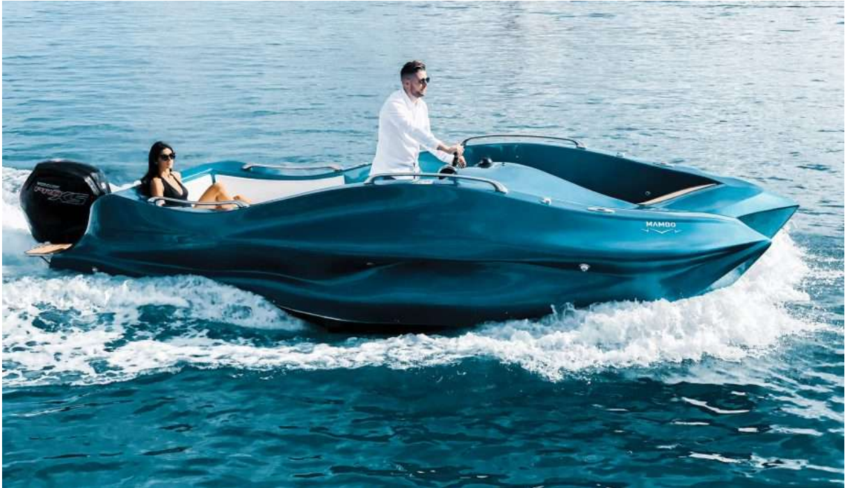
Ilustración 147: MAMBO, embarcación construida por impresión en fibra de vidrio. Fotografía de Dimitris Siali, Fuente: mby.com
