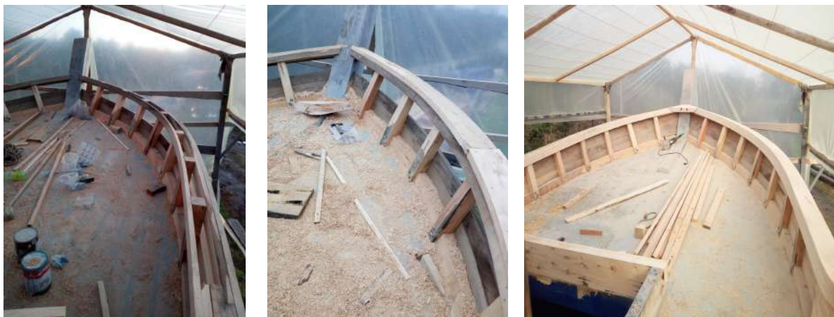
Ilustraciones 15, 16 y 17: Proceso de forrado de barraganetes e instalación de la tapa de regala (Calbuco, Chile); Fuente: @carpinteríaderibera (Facebook)
