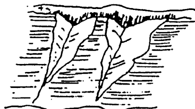
Deslizamiento de cuñas de roca
