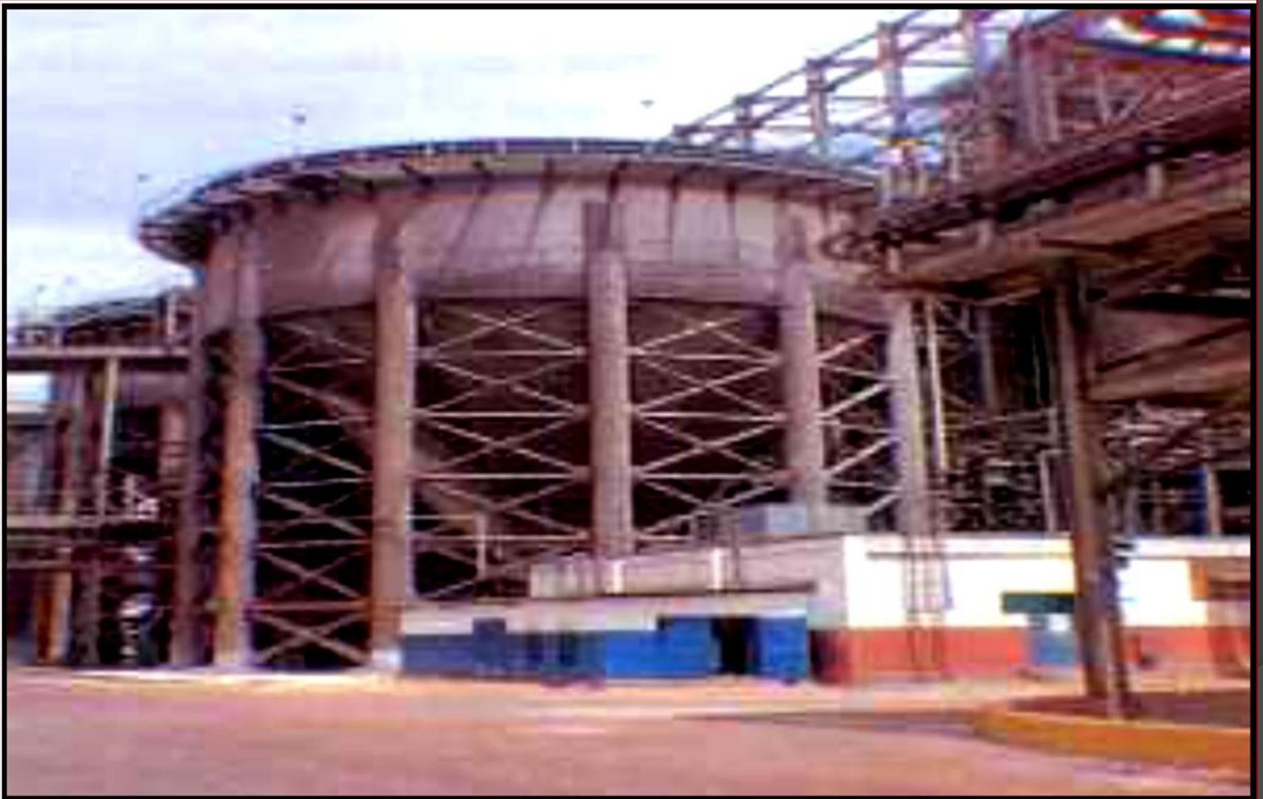
Foto N° 7: Ciclones de Clasificación de Hidratos Precipitados CVG Bauxilum, CxA
