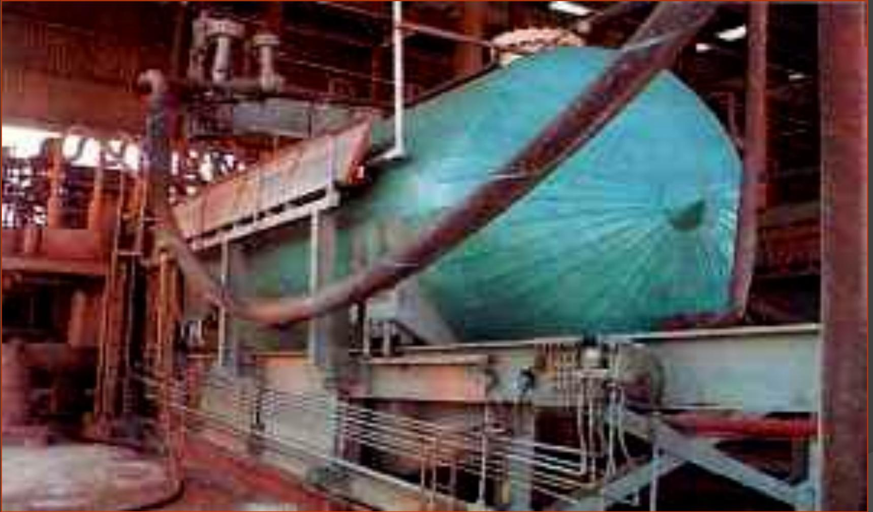
Foto N° 5: Filtro de Seguridad Kelly de CVG Bauxilum, CxA
