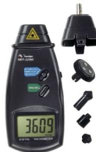
**Figura 3.** Tacômetro MDT-2238<sup>a</sup>.
