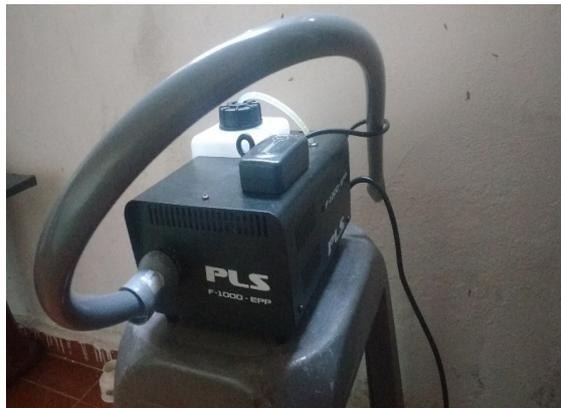
Figura 13 – Máquina de fumaça adaptada.
