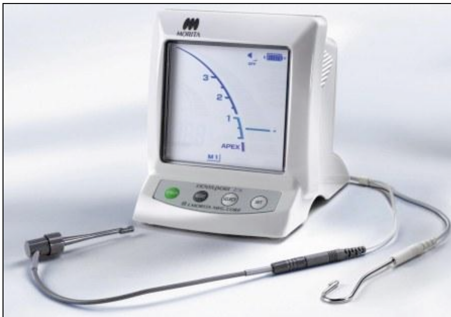
Fig. 1- Localizador apical Root ZX (J. Morita). Observar as quatro partes constituintes: alça labial, clip para lima, aparelho e fio conector.
