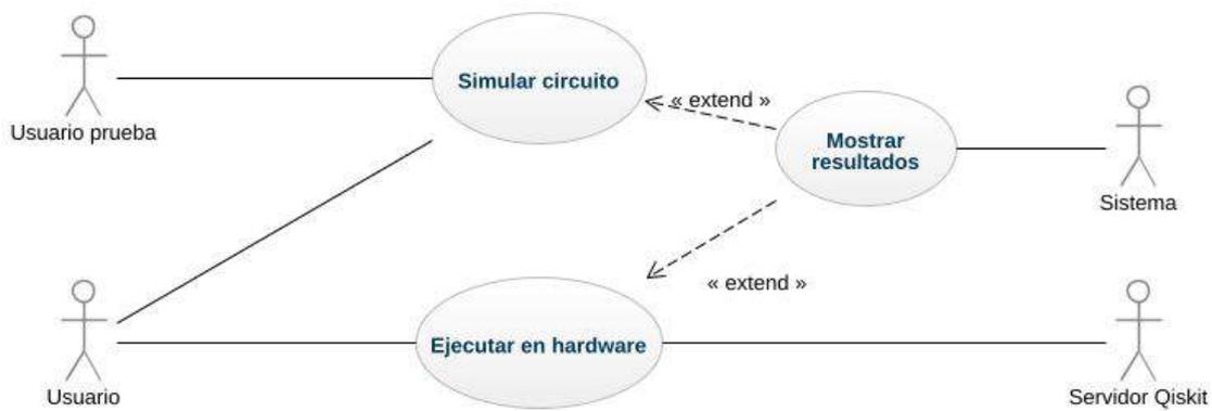
Figura 3.5: Diagrama de casos de uso de la característica Simulación y ejecución
