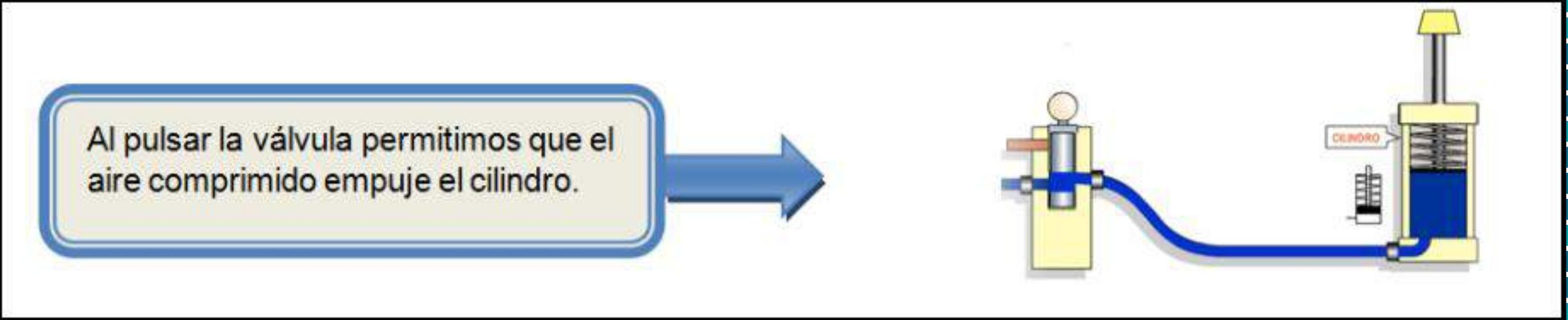
Los mandos neumáticos están constituidos por elementos de señalización, elementos de mando y un aporte de trabajo. Los elementos de señalización y mando modulan las fases de trabajo de los elementos de trabajo y se denominan válvulas.
