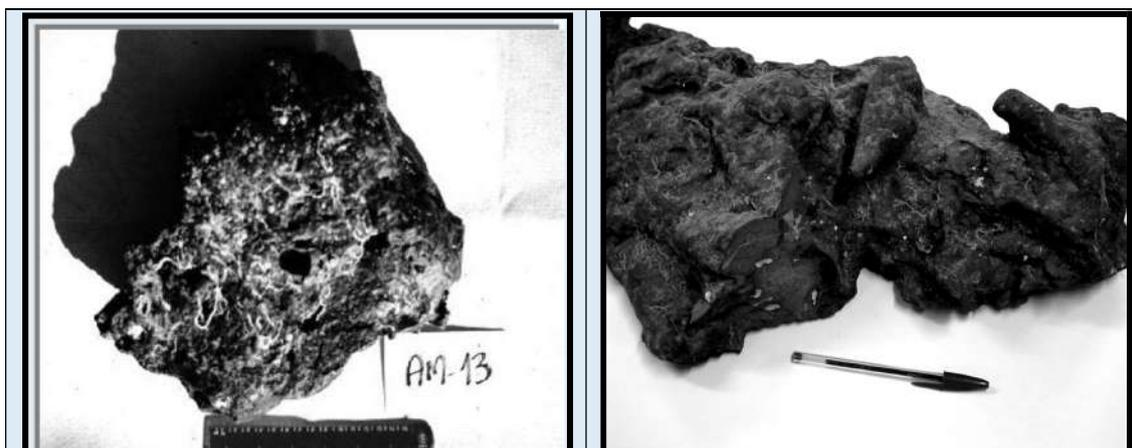
**Figura 83.** Fosforitos de fundo oceânico coletados na margem continental Sul brasileira nas profundidades de 365m (amostra à esquerda) e 495m (amostra à direita), que apresentaram teores de  $P_2O_5$  de 2,34% e 1,19%, respectivamente, em base aos minerais fluorapatita carbonática e a hidroxiapatita carbonática.
