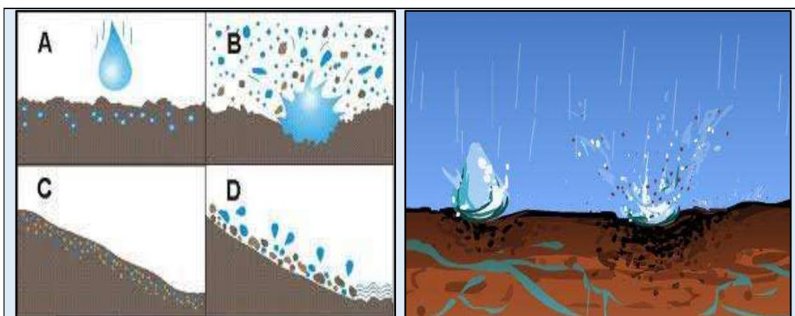
**Figura 4.** Exemplo típico da erosão ou corrosão hídrica causada pelo impacto da gota de água da chuva. Ao precipitar a chuva (A+B), a água toma dois caminhos: se infiltra na superfície, quando a cobertura vegetal presente faz dissipar a energia cinética da gota, ou causa erosão e deslocamento da massa d'água n superfície.
