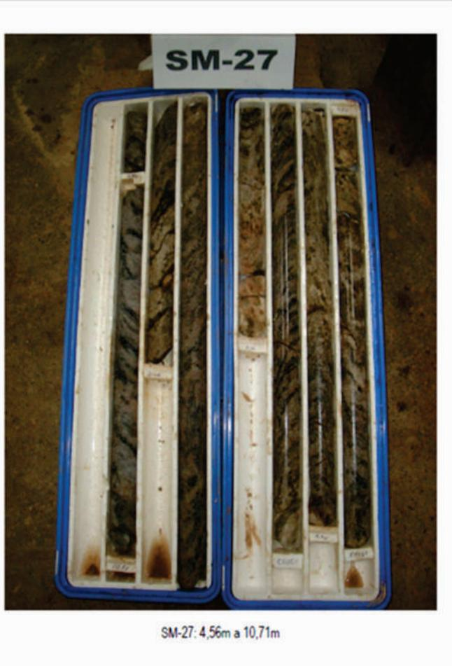
Figura 6. Resultado de sondagem rotativa.
