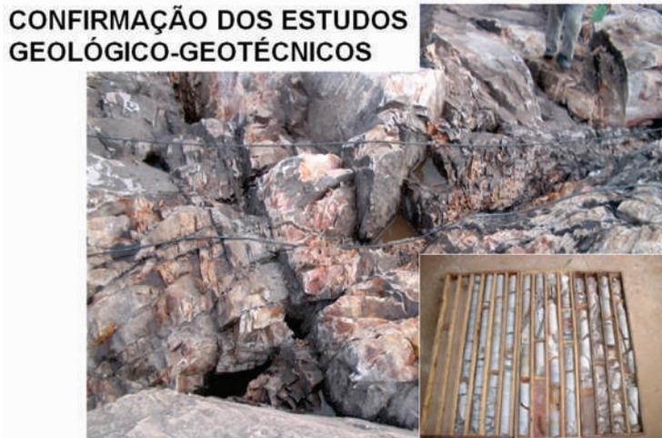
Figura 7. Maciço rochoso exposto x testemunho de sondagem rotativa
