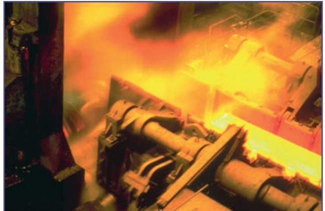
**T3c13** Equipo mecánico para manipulación de barras de acero caliente
