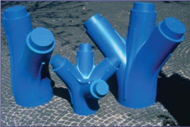
**T3c24** Nudo de acero moldeado para uniones, Terminal de Aeropuerto de Stuttgart
