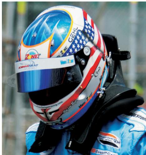
Figura 8. El HANS (Head and Neck Support System), que va unido al casco de los pilotos.
