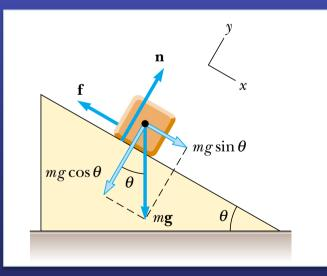
Para volver a la situación de equilibrio habrá que replantear las ecuaciones de movimiento sustituyendo  $f_s$  por  $f_k$  y reducir el ángulo a un valor  $\theta'_c$  tal que el bloque se deslice hacia abajo con velocidad constante
