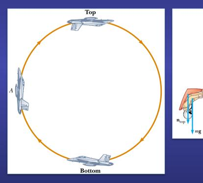
Analicemos el diagrama del cuerpo aislado del piloto en la parte de arriba del loop
