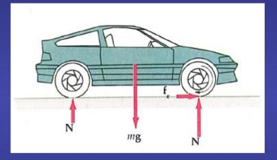
Si cada neumático rueda sin deslizamiento, su superficie de contacto con la carretera se encuentra en reposo relativo con ésta.
