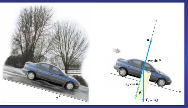
El peso va a tener ahora una componente a lo largo del eje x y una componente a lo largo del eje y
