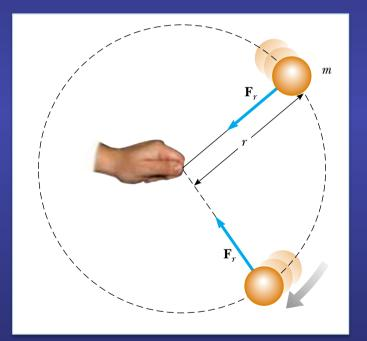
Partícula que se mueve en una trayectoria circular de radio *r* con velocidad uniforme *v* experimenta una aceleración centrípeta dirigida hacia el centro del círculo de módulo
