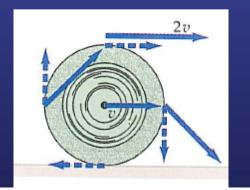
Superficie de contacto con el suelo se mueve hacia atrás con respecto al eje con velocidad *v*
