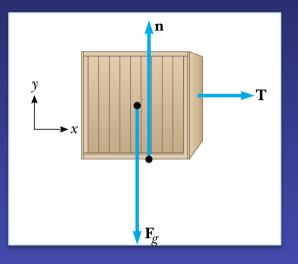
Paso 4: Aplicamos la segunda ley de Newton descompuesta en componentes
