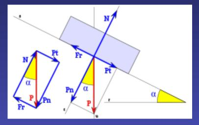
Descomposición del peso en una componente normal y otra tangencial al plano  $P_n = -mg\cos\alpha \qquad \qquad P_t = mg\sin\alpha$
