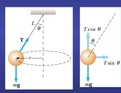
La bola está en equilibrio en la dirección vertical La bola sigue un movimiento circular en la dirección horizonta
