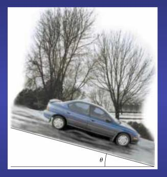
Cuando se trabaja con planos inclinados es conveniente escoger un eje de coordenadas con el eje *x* paralelo al plano inclinado y el eje *y* perpendicular al mismo
