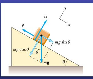
En el ángulo crítico, el bloque se encuentra en el umbral de deslizamiento, la fuerza de rozamiento tiene su módulo máximo
