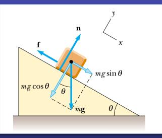
Seleccionamos un sistema de coordenadas con un eje *x* positivo paralelo al plano inclinado
