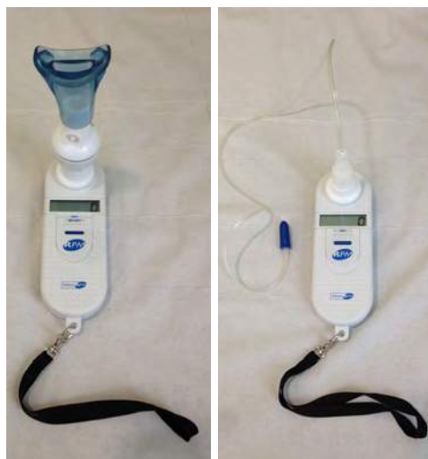
Figura 2. Manómetro con pieza bucal para determinación de PIM y PEM, y manómetro con pieza nasal para determinación de SNIP
