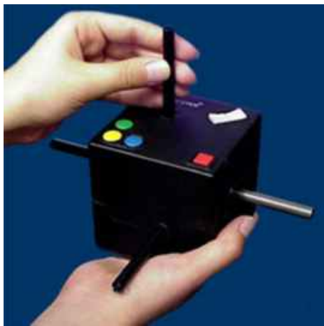
Figura 6 : Dispositivo inercial, Fakespace Systems Inc “CubicMouse “.
