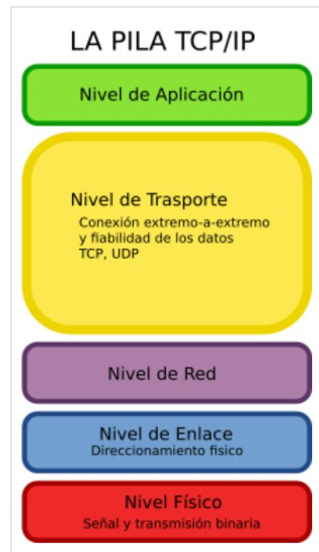
4. Capa de Enlace: la capa de red confía en esta capa para trasladar un paquete de un nodo al siguiente de la ruta. En concreto, en cada nodo, la capa de red pasa el datagrama a la capa de enlace, que entrega el datagrama al siguiente nodo existente a lo largo de la ruta.
