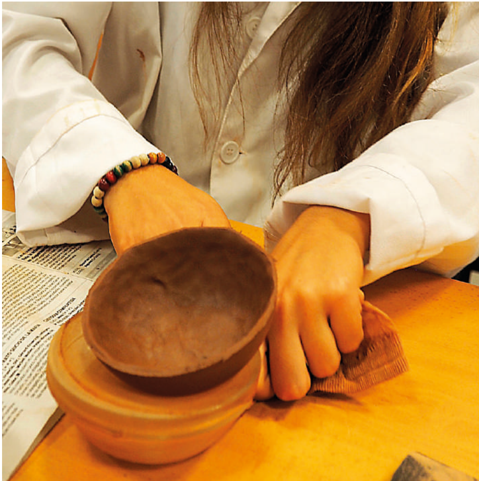
Imagen 74. Extracción del molde estirando suavemente el tejido cuando la arcilla está en dureza de cuero
