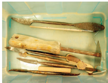
Imagen 31. Estecas metálicas, retorneadores y formones
