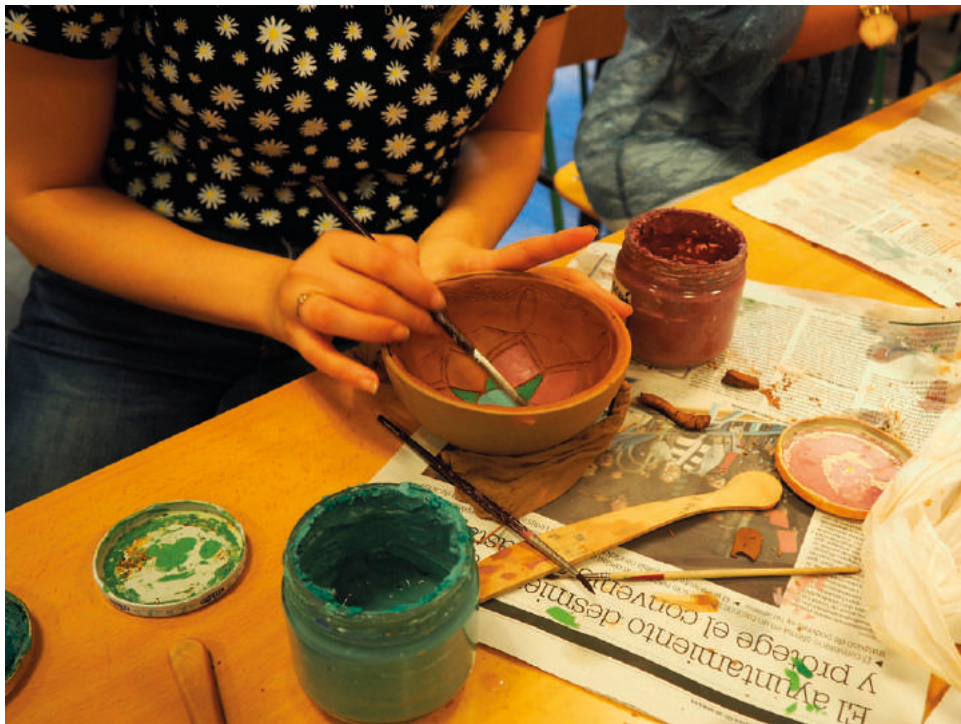
Imágenes 108 y 109. Aplicación de engobes a pincel y piezas terminadas para bizcochar
