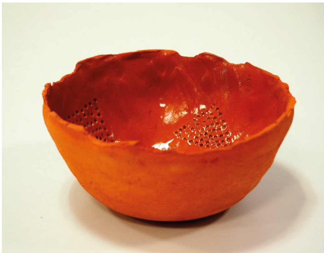
Imagen 125. Cuenco de arcilla roja bizcochado a 840 °C. Posterior vidriado con frita alcalina a 980 °C
