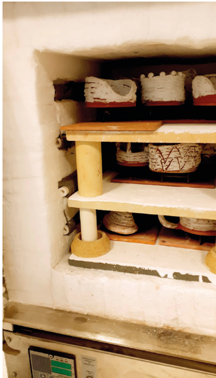
Imagen 142. Interior del horno con carga de piezas vidriadas y sobre trípodes metálicos
