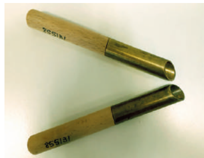
Imagen 44. Muestra de troqueles para perforar la arcilla
