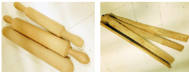
Imagen 39 y 40. Rodillos y listones de madera para hacer placas
