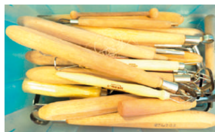
Imagen 46. Vaciadores variados de fleje y alambre con mango de madera
