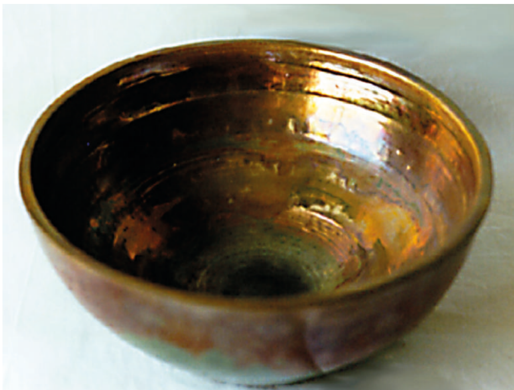
Imagen 143. Piezas con esmalte metalizado sobre arcilla roja de alfarero. Cocción a 1050 °C. con reducción en el enfriamiento entre 800 °C y 600 °C
