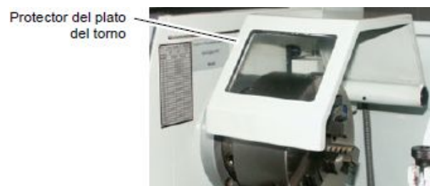
Imagem 60 - Proteção de parte móvel com interruptor de segurança quando se levanta, fonte - Manual Quantum D320x920 SG
