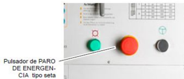
Imagem 58 - Botão de emergência, fonte - Manual Quantum D320x920 SG
