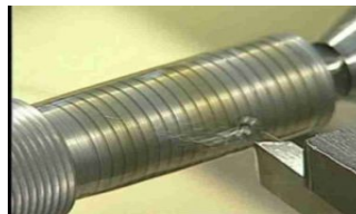
Imagem 48 - Roscagem Externa. Fonte - Tecnologia II
