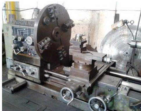
Imagem 6 - Torno de placa, marca nardini-3000-x-1300-mm
