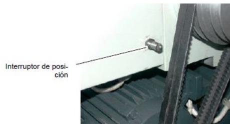
Imagem 59 - Interruptor de segurança quando se abre a tampa, fonte - Manual Quantum D320x920 SG
