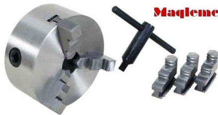
Imagem 33 – Bucha com o conjunto de grampos montados para peças de grande diâmetro. Fonte – Gladimir Silva
