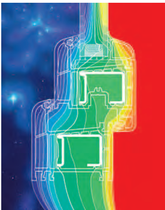
Termografía de una sección de EuroFutur Elegance
