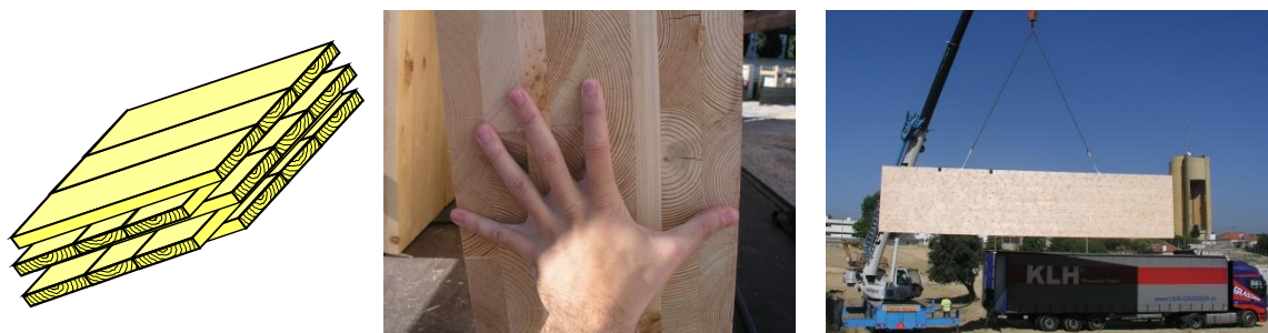
Figura 1 – Painel de madeira lamelada-colada cruzada.
