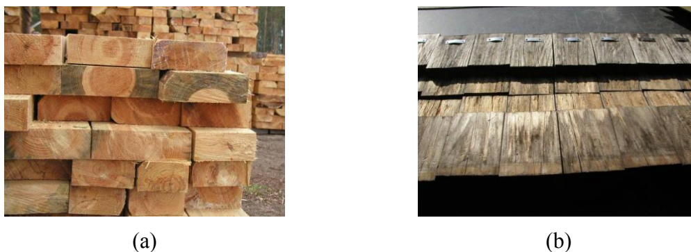
Figura 1 – a) azulamento de madeira verde; b) azulamento em serviço e bolores.
