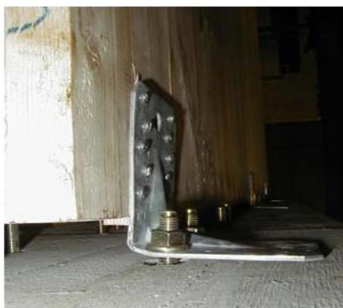
Figura 11 – Exemplo de comportamento de ligação sujeita a simulação de ação sísmica (elementos cedidos por Bruno Dujic)
