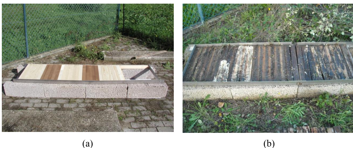
Figura 4 – Ensaio de campo “doble layer”. a) No início (2006); (b) depois de 6 anos de exposição (2012).
