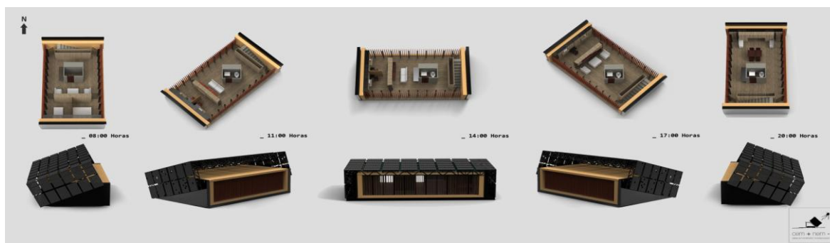
Figura 9 – Diversidade espacial em função da reação da casa com o sol e com o utilizador.
