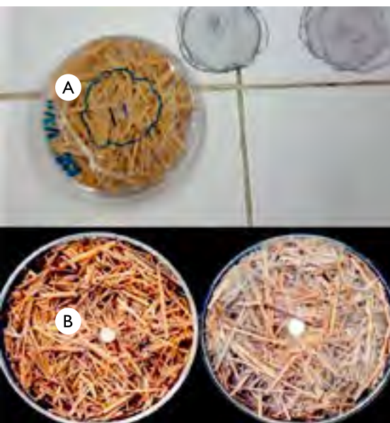
Figura 22. A) Esquema de evaluación del área micelial en la caja de Petri con sustrato orgánico para su medición con el programa ImageJ. B) Crecimiento progresivo del micelio a partir un implante.
