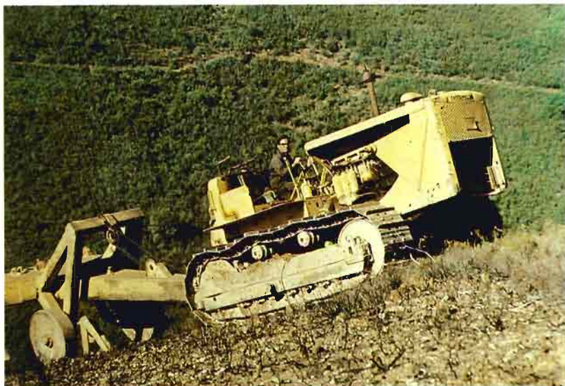
Fig. 9.-En AS también se utiliza el subsolado, que bien planificado emplea menos energía que los arados.
