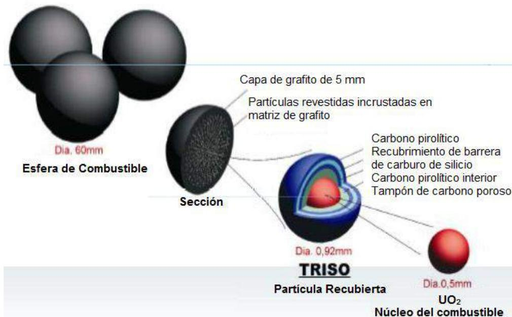
Fig.30: Partículas de combustible de los reactores VHTR, presentan forma esférica, y las capas internas que la forman. (Sink, 2017)
