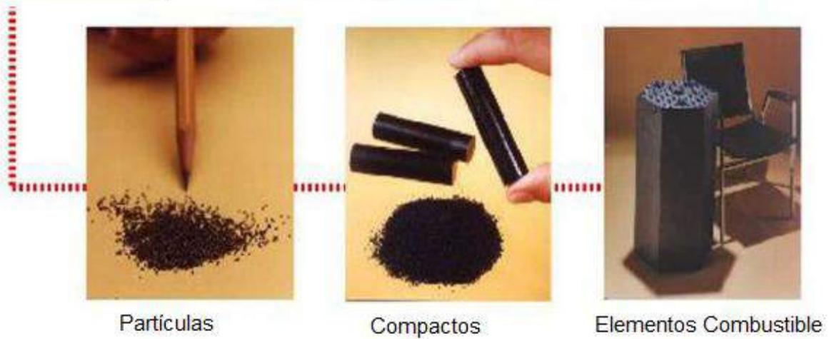
Fig.32: Forma del combustible del reactor HTTR, forma de bloque prismático. (Sink, 2017)
