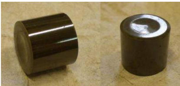
Fig.4: "Pellets", o combustible MOX. Pastillas de combustible sintético aptas para la introducción en las barras de combustible de los reactores nucleares. Carlevaris, R., Gómez Constenla, C., Rey,E.A; 2015)
