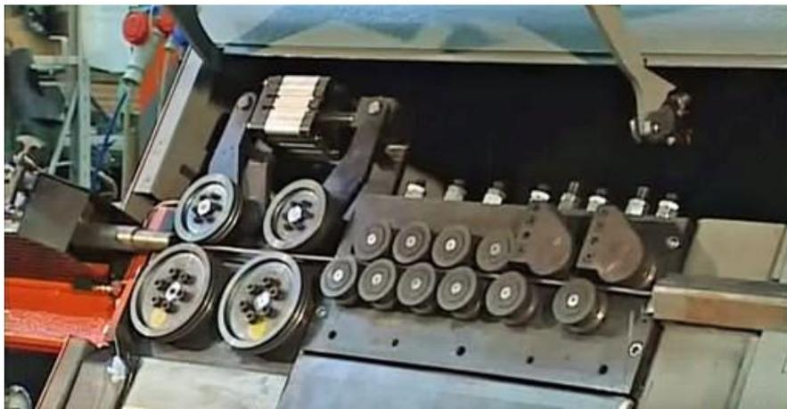
Figura 6 – Bobinas passando pelas roldanas
