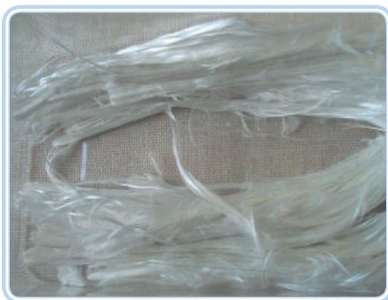
**Figura 16.1: Fibras de amianto (tremolite)**
