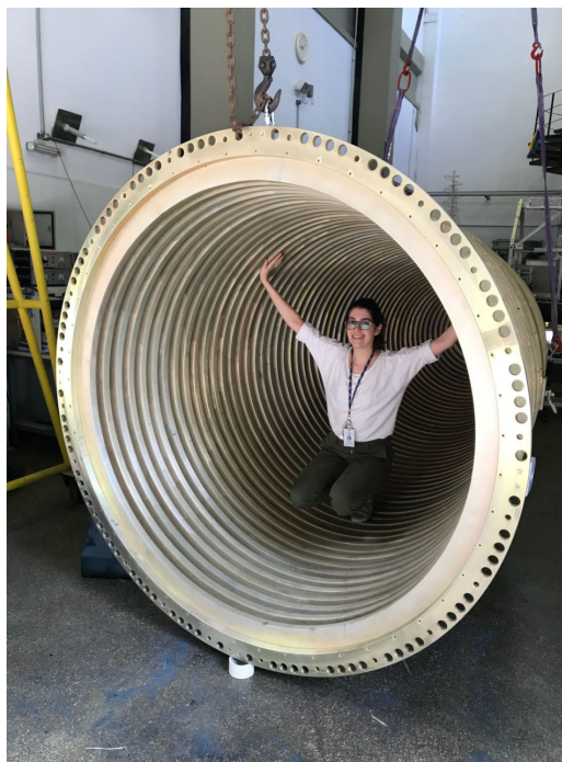
Figura 2.16: Uma das 50 antenas do radiotelescópio BINGO, em construção na DAS/INPE. Fonte: L. Reitano.
