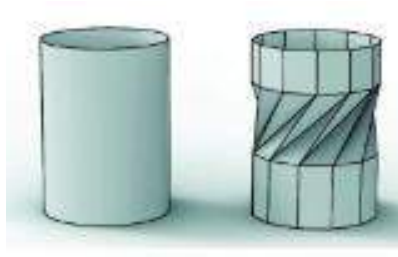
Figure 6: motif diagonal (Un cylindre et ses motifs de pliage constitués de triangles et de trapèzes)
