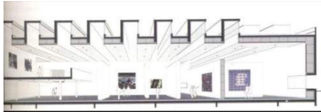
Figure 61: les lanterneaux (Source : http://dispositif.eclairage.archi.musee.fr )
