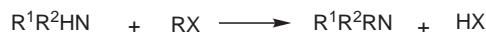
FIG. 5.68 – Bilan général d’une substitution nucléophile d’une amine sur un dérivé halogéné : un atome d’hydrogène porté par l’atome d’azote est remplacé par un radical hydrogénocarboné ; on obtient une amine plus substituée.
