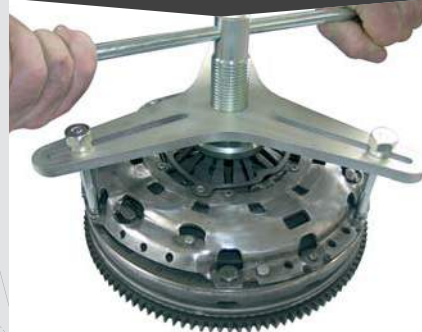
Démontage d'un embrayage
