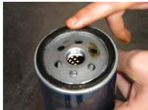
Penser à huiler la portée du joint du filtre
