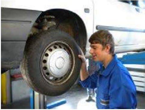
Vérification du ronflement de roulement
