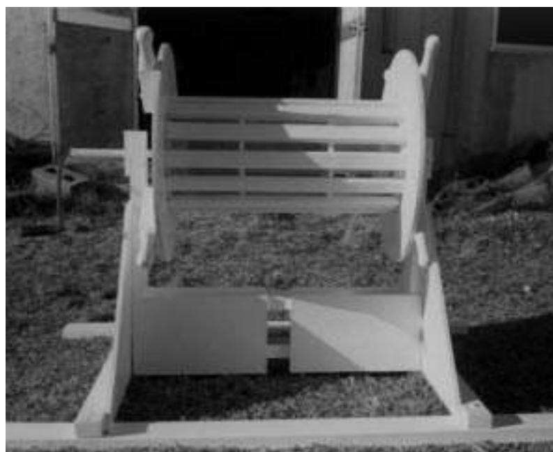
Figure 3 : Moulinet en bois construit pour emmagasiner et utiliser des palangres verticales.
