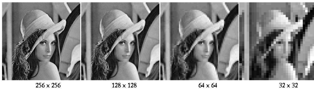
FIGURE 3.2 – Effets du sous-échantillonnage sur le visage de Lena. À gauche, l'image originale, progressivement dégradée par l'oubli, sur le tableau bitmap de 3 lignes sur 4, 7 lignes sur 8 puis 15 lignes sur 16. La compression est brutale, avec un artefact de blocking immédiatement perceptible. Il est heureusement possible d'être plus efficace!
