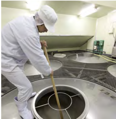
Le moût est mélangé pour abaisser sa teneur en gaz carbonique. L'intervention du tôji , qui surveille la fermentation, est cruciale.
