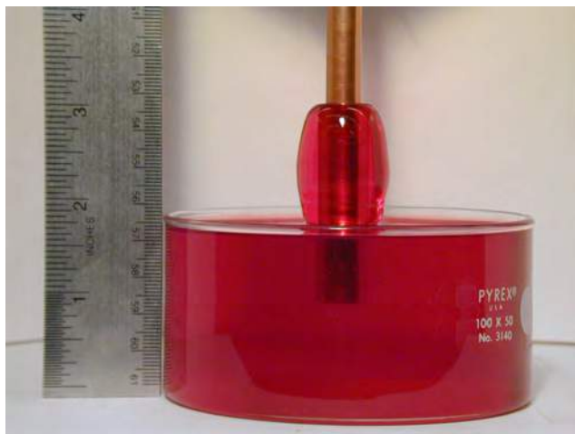
Figure 1.11 : effet Weissenberg. C'est la remontée d'un liquide polymérique le long d'un cylindre plongé dans un bain et mis en rotation.
