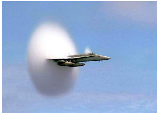
Figure 1.7 : passage du mur du son par un avion militaire [DR]. L'onde de choc induit un changement brutal de pression, qui provoque la condensation de la vapeur d'eau et la formation de micro-gouttelettes qui matérialise l'onde de choc aux abords de l'avion.
