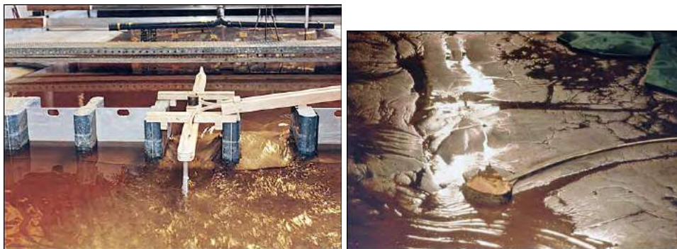
Figure 2.12 : étude sédimentologique du bassin du mont Saint-Michel (France) à l'aide d'un modèle réduit. Source : Sogreah (Grenoble).
