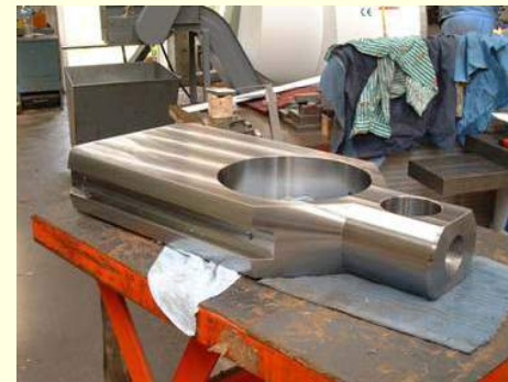
Pièce finie après la rectification
