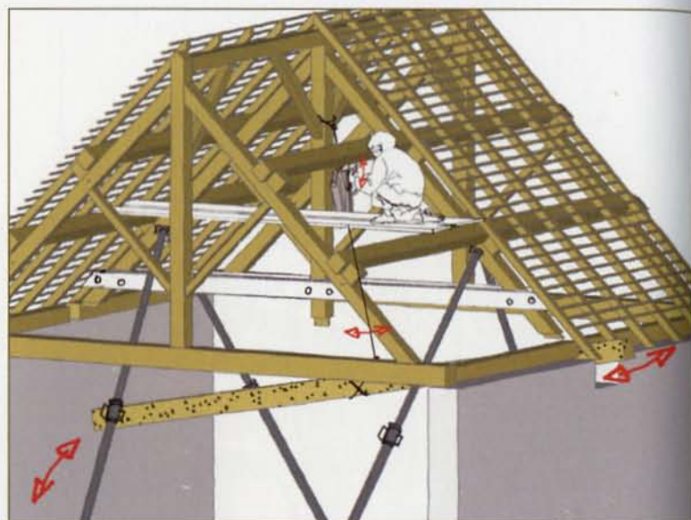
6. Après avoir ménagé un point de fuite dans la maçonnerie d'un des murs porteurs, et en s'aidant d'un Tirfor®, on dégage l'entrait.
