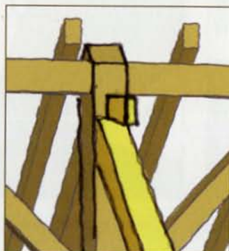
8. Lorsqu'il sera remis en place, une clé sera entrée en force dans la mortaise déboulée pour recréer les propriétés de l'assemblage.
