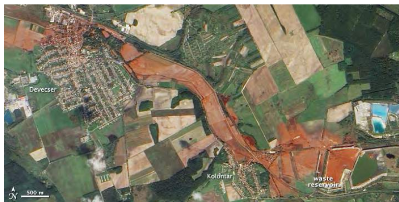
Figure 3.15 : zones inondées par la rupture du bassin de décantation de l'usine d'Ajka en Hongrie. Photographie satellitaire prise le 9 octobre 2010. Source : NASA .
