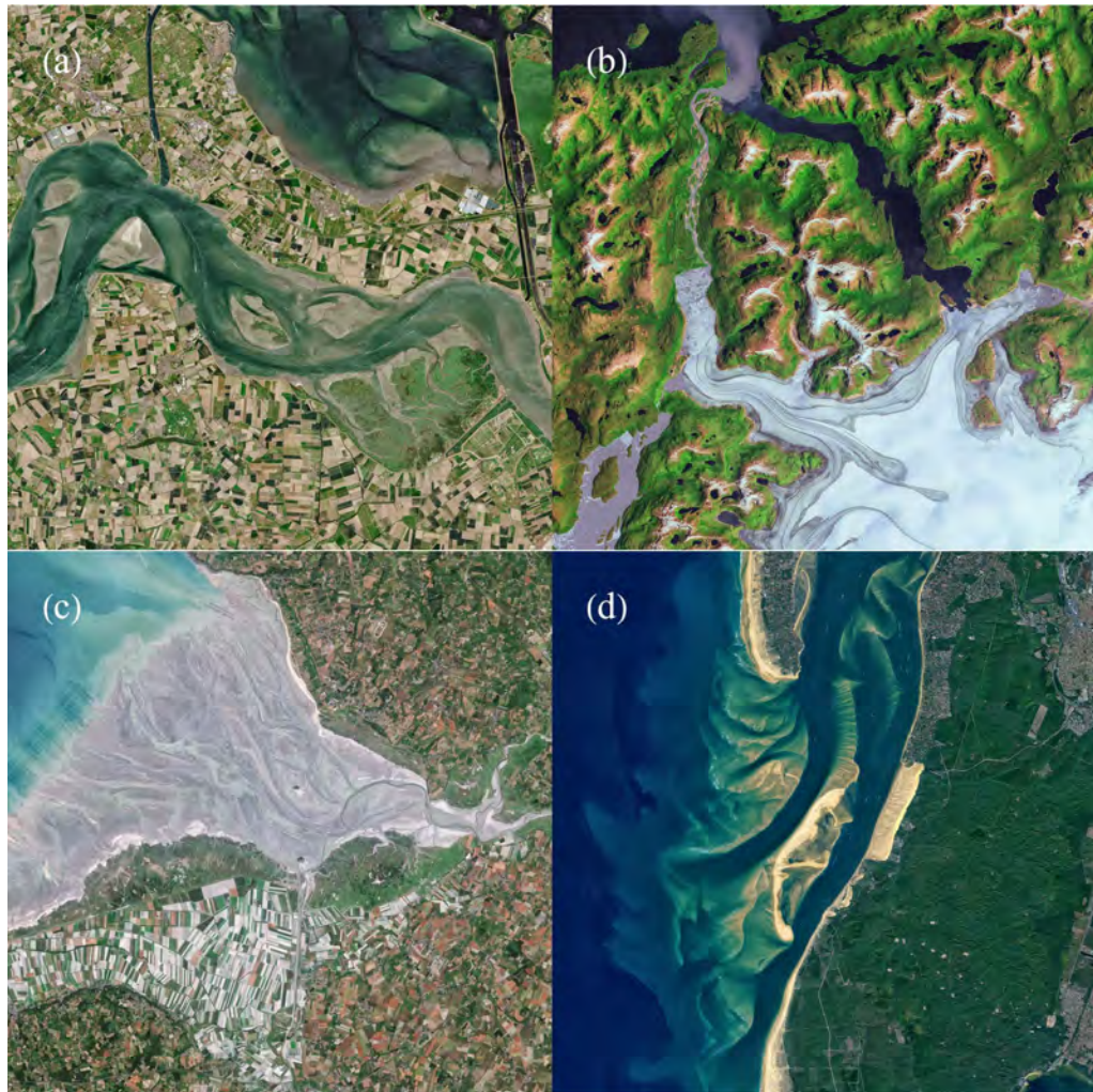
Figure 1.15 : différents types de morphologies de lit à grande échelle. (a) Région du Zélande aux Pays-Bas, près de Terneuzen (frontière entre la Belgique et les Pays-Bas). Les couleurs claires représentent des zones peu profondes de l'estuaire de l'Escaut avec plusieurs bancs de sable visibles. Les couleurs plus foncées indiquent une charge sédimentaire plus élevée et des eaux plus profondes (mission Sentinel 2, 2020); (b) glacier Pie XI au Chili alimentant les eaux du lac Greve en Patagonie (mission Landsat 8, 2016); (c) baie du mont Saint-Michel éperon granitique situé à quelques centaines de mètres des côtes dans l'estuaire de la Rance en Normandie. Le marnage y est important – de l'ordre de 15 m – et met à découvert de vastes étendues (mission Sentinel 2, 2017); (d) baie d'Arcachon (France) avec la dune du Pilat – 2,7 km de long, 500 m de large et 110 m de hauteur – (satellite japonais ALOS, 2009). Source : European Spatial Agency .
