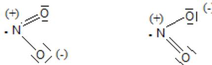
Ces deux structures ne diffèrent que par la localisation des électrons p ou n (doublet libre). On passe d'une formule à une autre par simple déplacement de ces électrons.
