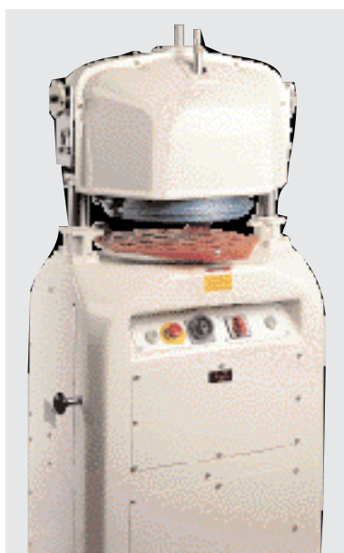
Figure 14 Le mouvement de fermeture du capot est actionné par un dispositif de commande à deux mains.
