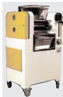
Figure 12 Râpeuse-effileuse équipée d'un protecteur mobile associé à un dispositif de verrouillage contrôlé par un interrupteur.
