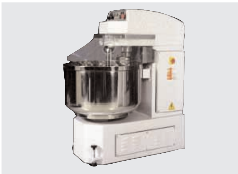
Figure 9 Le bras mélangeur en spirale est engagé dans la cuve et le dispositif de protection est placé en position correcte. La machine peut être mise en marche.
