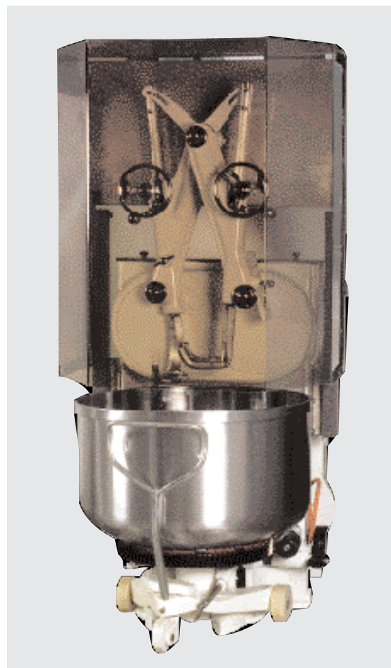
Figure 4 Pétrin à deux bras relevables équipé d'un protecteur mobile contrôlé par un interrupteur.
