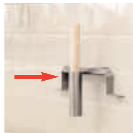
Figure 10 a Support avec poussoir et protection des mains installés à proximité directe de la machine.
