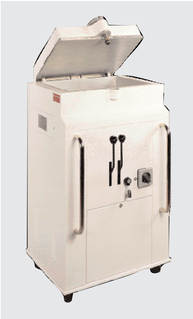
Figure 15 Diviseuse, position du couvercle assurée par ressorts de pression.
