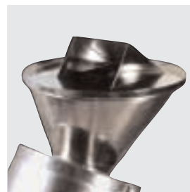
Figure 11 Protection de l'entrée d'une machine à râper.
