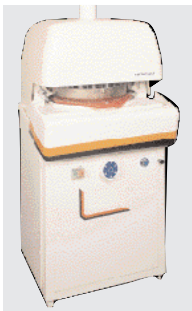
Figure 13 Le cycle de travail de la diviseuse-bouleuse est mis en marche par la fermeture de la protection contrôlée par un interrupteur.
