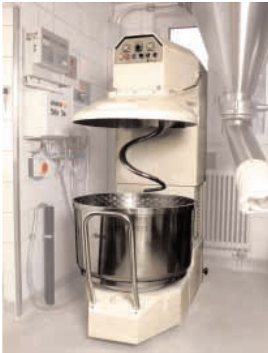
Figure 8 La mise en marche de la machine ne doit pas pouvoir s'effectuer aussi longtemps que le bras mélangeur en spirale n'est pas dans la cuve et que le dispositif de protection n'est pas en position correcte.
