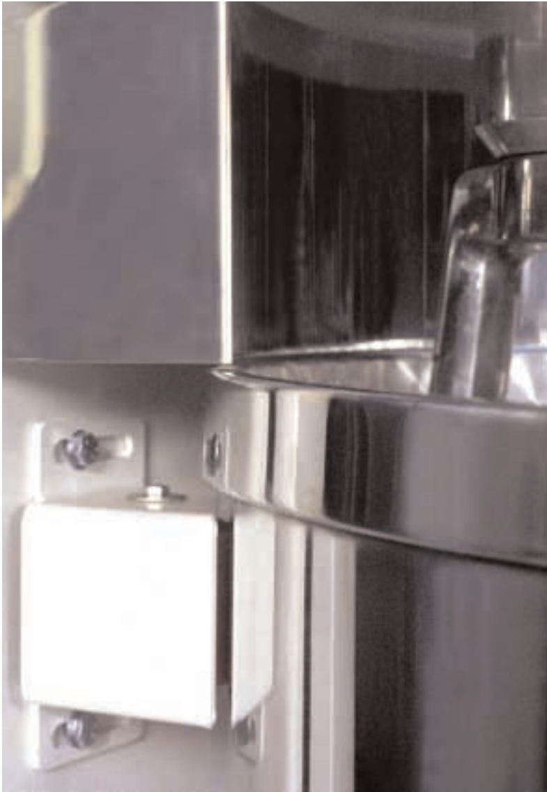
Figure 5 Sécurité de la zone d'introduction entre la cuve et le socle de la machine.
