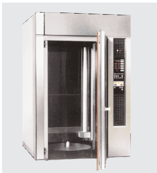
Figure 23 Four avec plaque de base entraînée. Lors de l'ouverture de la porte, l'entraînement de la plaque de base est mis à l'arrêt automatiquement.
