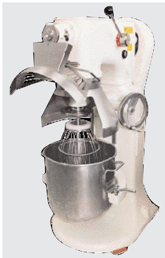
Figure 7 Batteur/malaxeur à mouvement planétaire équipé d'un dispositif de protection.
