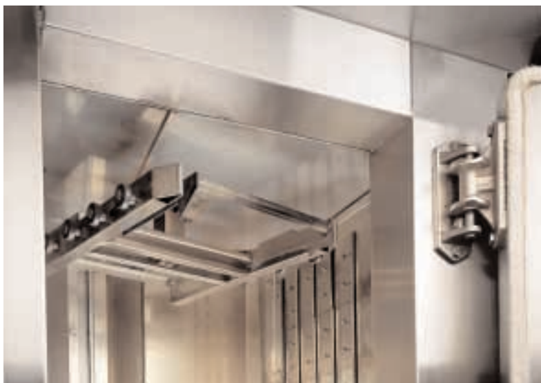
Figure 22 Four avec accouplement à friction entre l'entraînement et le chariot.
