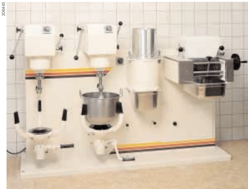
Figure 10 Machine combinée à râper et à couper avec deux pétrins chauffants et râpeuse-effileuse à deux cylindres (voir prescriptions SN EN 454:2000).
