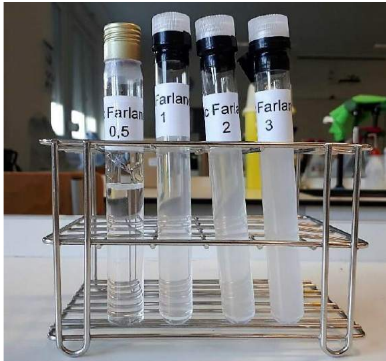
Fig. 24: Etalon de Mc Farland servent de standard de turbidité pour préparer les suspensions bactériennes.
