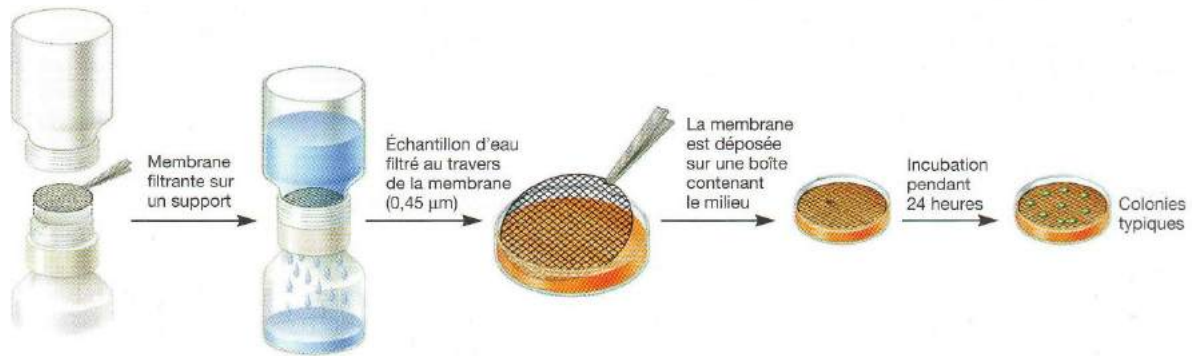
Figure IV.4 : Le procédé de filtration sur membrane.
