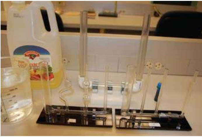
Figure 2.4. Le matériel utilisé dans l'activité 2.4. Le manomètre en forme de U (partie A) est montré en arrière plan. Au premier plan nous avons des tubes reliés de différentes formes (à gauche) et des tubes reliés cylindriques avec des bras de diamètre différent (à droite).
