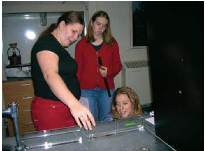
Figure 5.1. Vitesse d'onde et profondeur. Les étudiants mesurent le nombre d'allers-retours dans un bassin dans lequel la profondeur de l'eau est de 1,5 cm.
