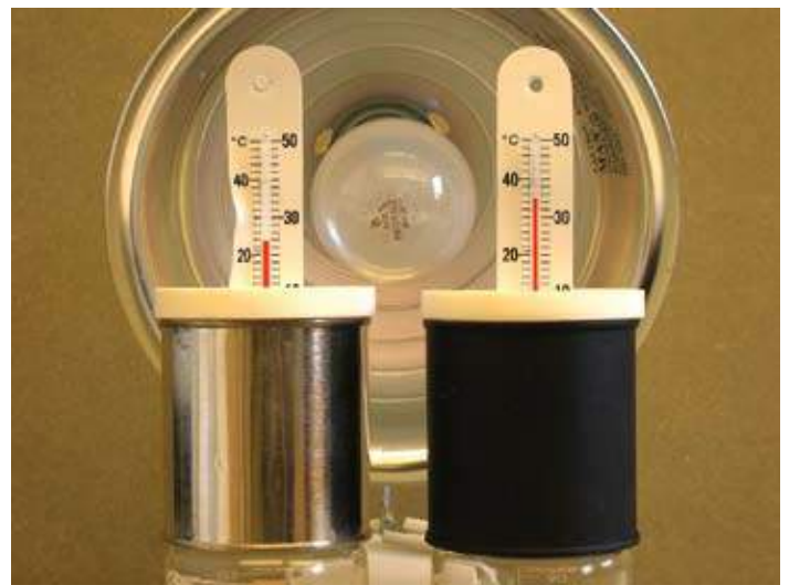
Figure 4.1. Matériel pour l'activité 4.1. Suivant l'éclairage de la boîte brillante et la boîte noire les thermomètres montrent une température différente.
