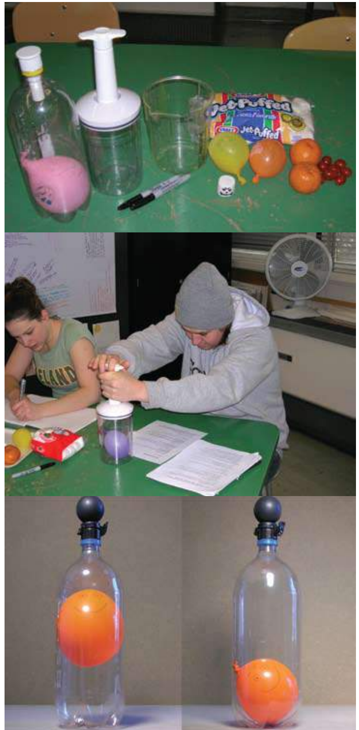
Figure 2.5. (en haut) Matériel pour l'activité 2.5. (au milieu) Tester un récipient rempli d'air sous vide. (en bas) Un ballon rempli d'air sous pression atmosphérique (à gauche) et après que l'air soit pompé dans la bouteille (pression accrue; à droite).
