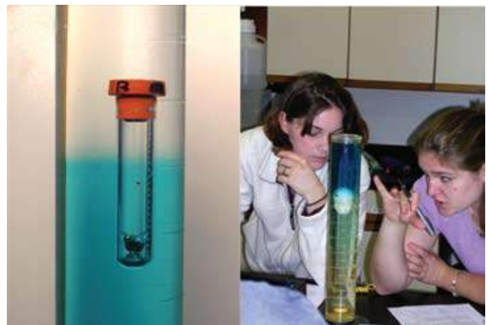
Figure 5.3. Oscillations de Flottabilité . Un flotteur de densités intermédiaire entre deux couche de densité différente (l'une plus dense et l'autre moins dense que le flotteur). Pousser vers le bas le flotteur oscillant avec une fréquence qui dépend de la différence de densité entre les deux couches.
