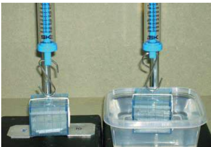
Figure 3.1 Dispositif pour l'activité 3.1 dans l'air (à gauche, les deux poids reposent sur la table) et dans l'eau (à droite).
