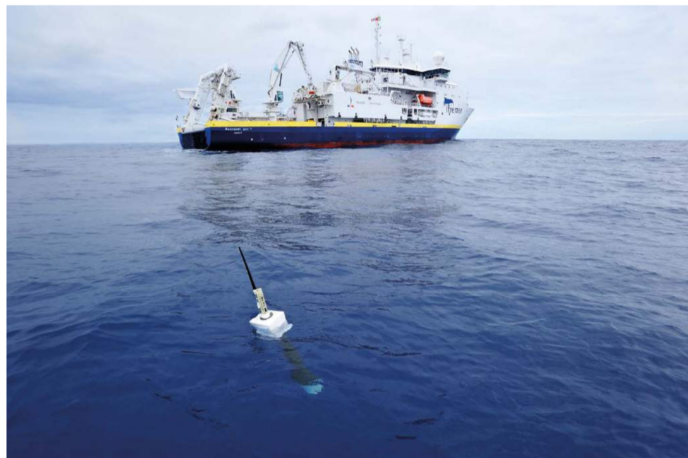
© Ifremer / 2009 / Olivier DUGORNAY Mise à l'eau d'un profileur Arvor depuis le navire océanographique Pourquoi pas ? de l'Ifremer.
