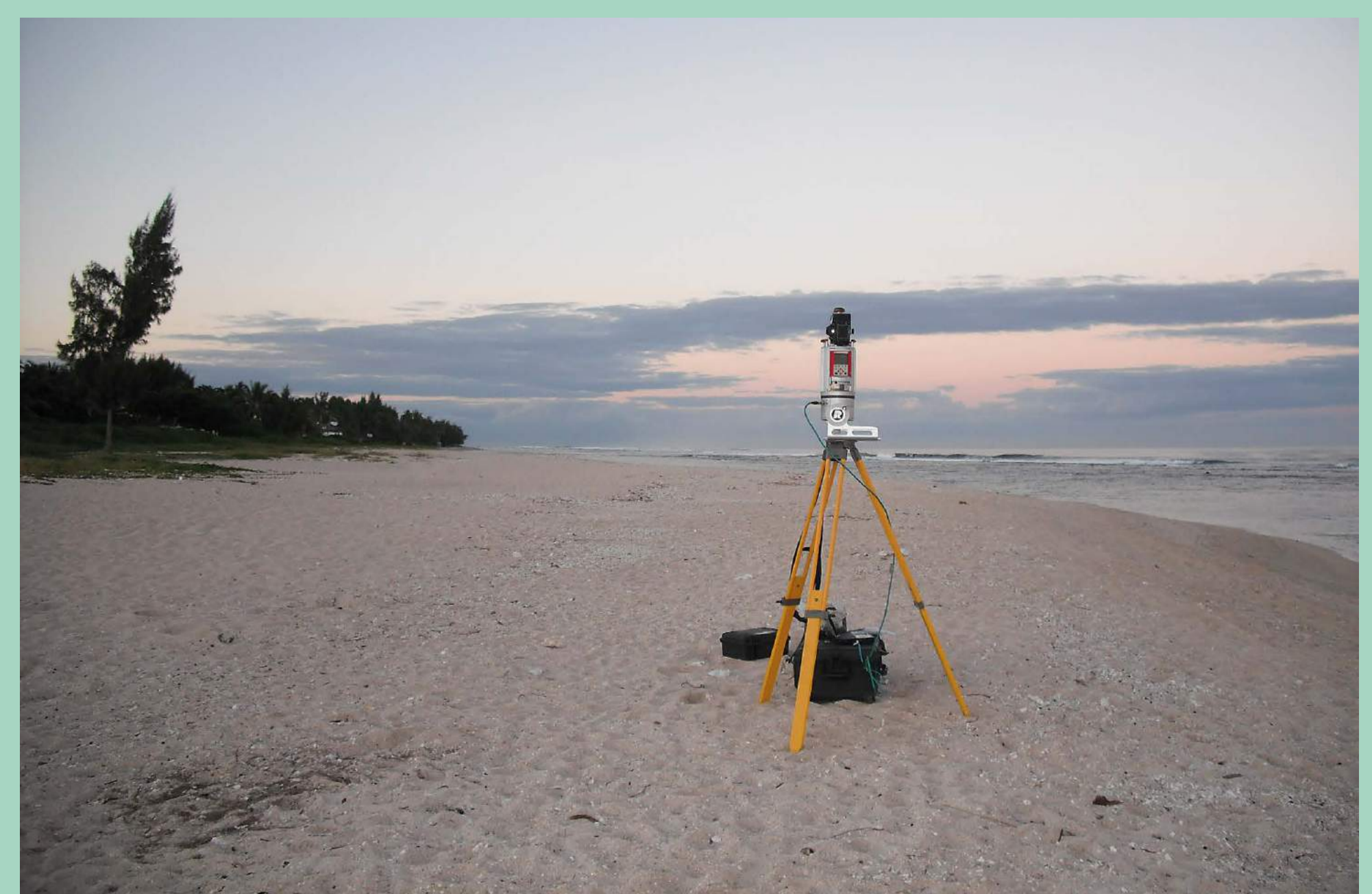
© Marion Jaud / CNRS Suivi topographique par scanner laser terrestre d'une plage corallienne sur la côte Ouest de l'île de la Réunion dans le cadre du Service national d'observation DYNALIT.
